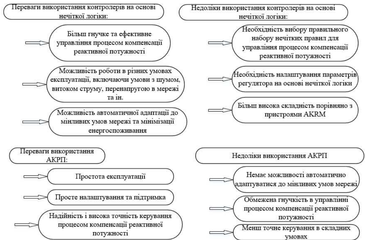
Рисунок 4.4 – Порівняння АКРП і КРП на основі нечіткої логіки для компенсації реактивної потужності
