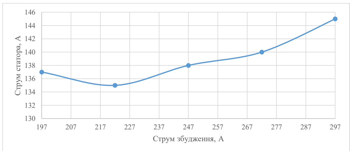
Рисунок Г.2 – Графік зміни струму статора від струму збудження двигуна СДН-2-17-44
