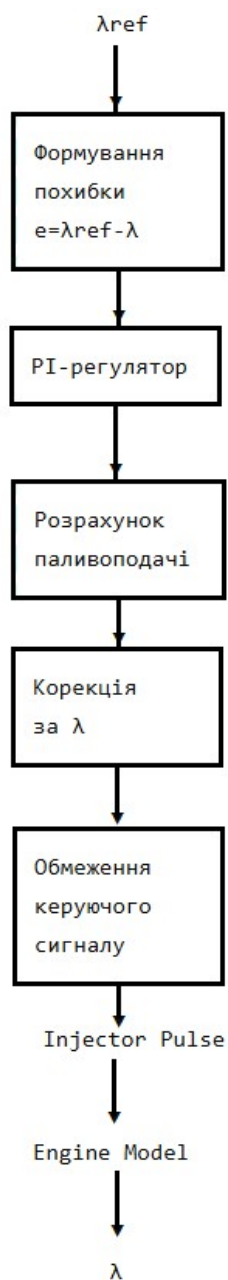
Рисунок 2.6 - Структура підсистеми ECU
