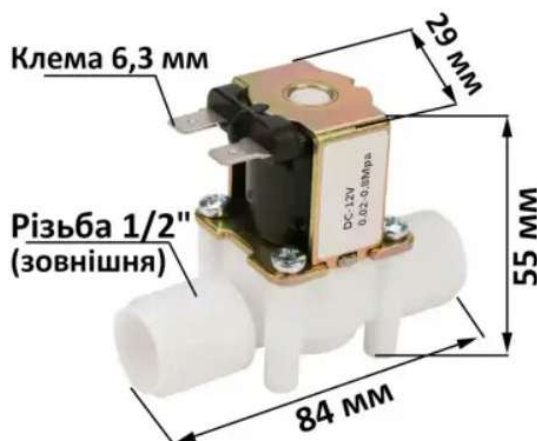
Рисунок 2.8 – Електромагнітний клапан
