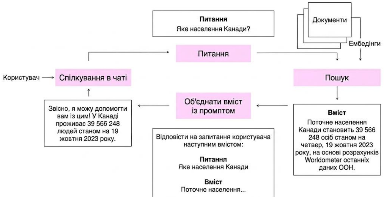
Рисунок 2.2 – Алгоритм роботи RAG систем [3]
