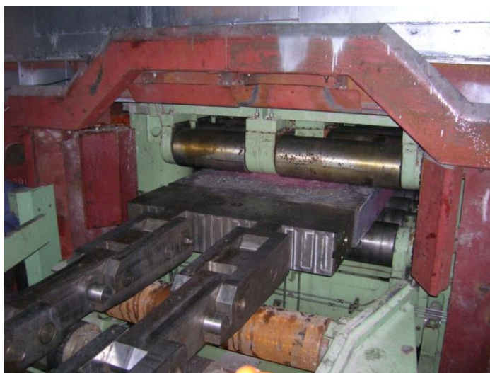
Рисунок 1.1- Фрагмент вузла машини для безперервної розливання сталі ПАТ «Арселор Міттал Кривий Ріг»
