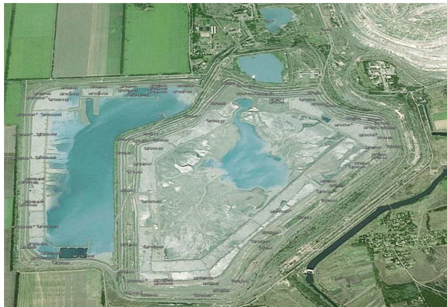
Рис. 3.2. Загальна схема розташування пунктів КВА на греблях хвостосховищ «Східна карта» і «Західна карта»
