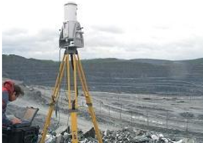
Рис. 5.5. Лазерний сканер Riegl LMS-Z420i при вимірюванні ділянки на кар'єрі
