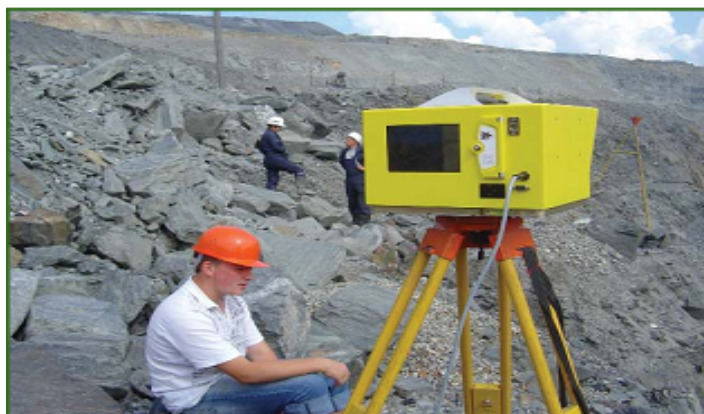
Рис. 5.4. Приклад зйомки відкритого гірничого вироблення лазерною скануючою системою
