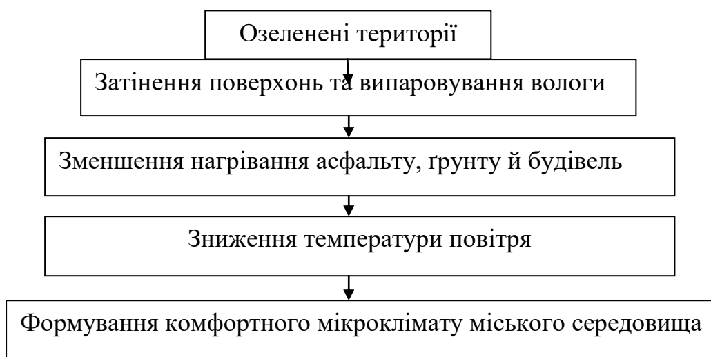
Рис. 3.4 Схема впливу озеленення на температурний режим
