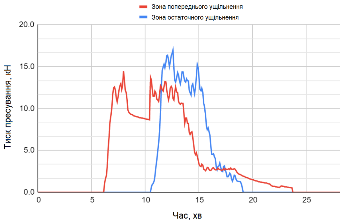
Рисунок 3.23 – Зміна тиску в екструдері при виготовленні брикетів складу R1 (без біовуглецю)
