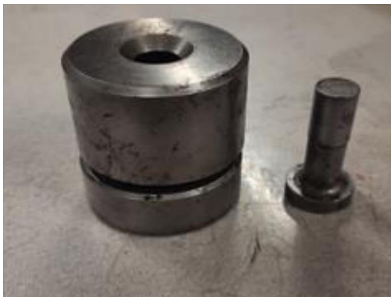
Рисунок 2.3 – Прес-форма для виготовлення брикетів
