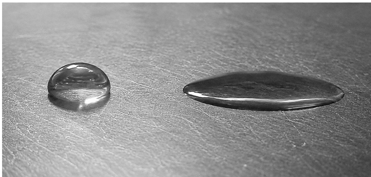
Рисунок 3.2 – Крапля води (ліворуч) та розчин органічного зв'язуючого (праворуч) на полірованій поверхні.
