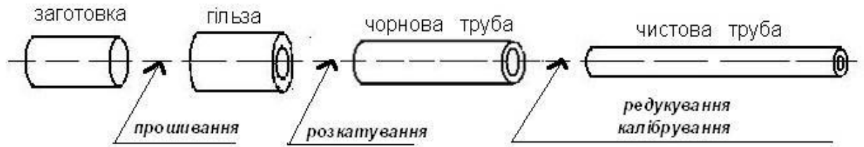
Рисунок 1.2. Технологічна послідовність виготовлення безшовних труб
