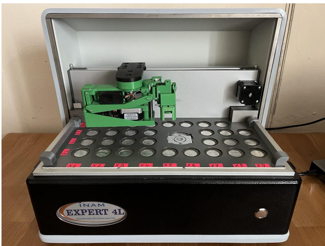
Рисунок 3.1 – Обладнання EXPERT 4L для проведення експрес-аналізу хімічних складників шихти
