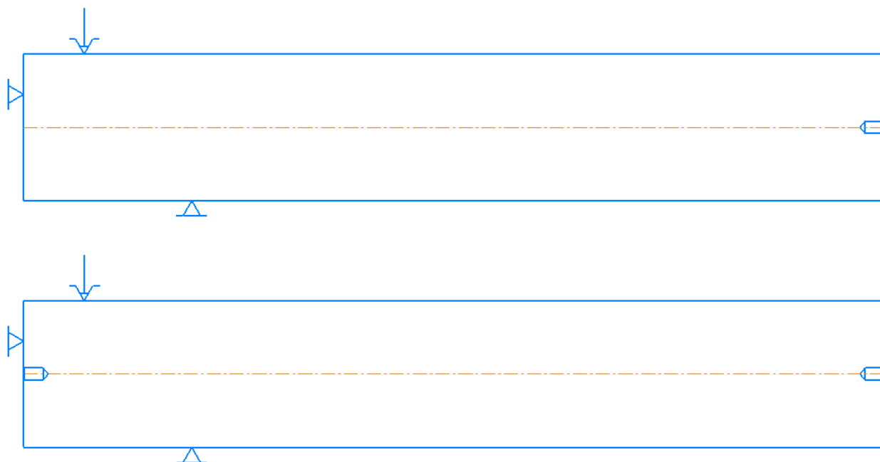
Рисунок 2.2 - Розмітка і центрування отворів.
