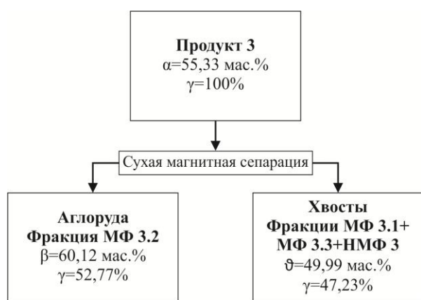
Рис. 6. Характер перераспределения материала Продукта 3 в результате его сухой магнитной сепарации.
