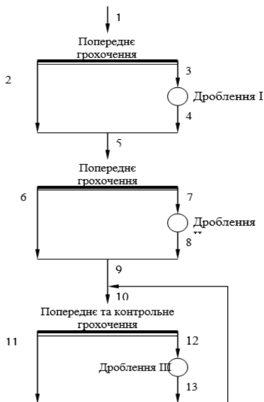
Рис. 3.9 Схема тристадійного дроблення із замкнутим циклом у третій стадії
