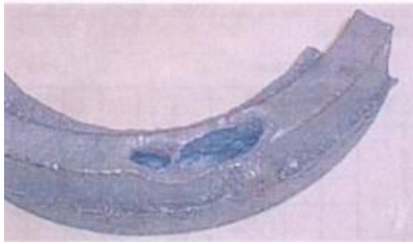
Рис. 1.9 – Раковина газоусадочна, матова, окиснена, неправильної форми, гладко-шорстка
