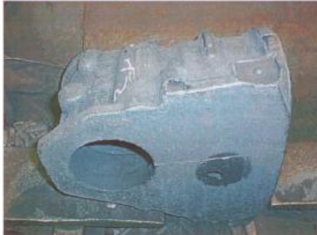
Рис. 1.8 – Виливка «Корпус передачі» з дефектом: раковина плескатої форми (пузирі підкоркові), окиснена, сіро-синього кольору, блискуча
