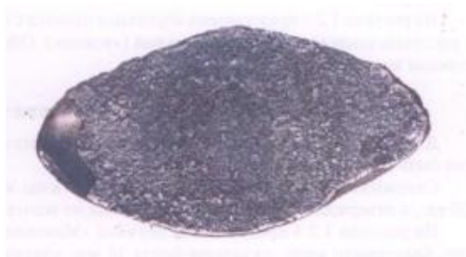
Рис. 1.3 – Раковина гладка, світла, локальна, більше 6 мм, відома також як «вскип»
