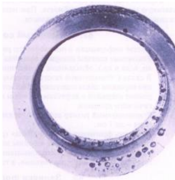
Рис. 1.6 – Вилиок «Фланець» з раковиною сферичної форми, поверхня раковини має кольори мінливості
