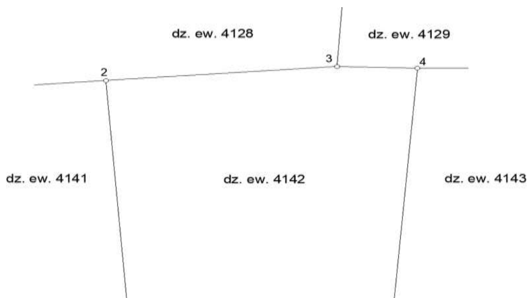
Рис. 3.9 - Ескіз розташування відновлених межевих знаків
