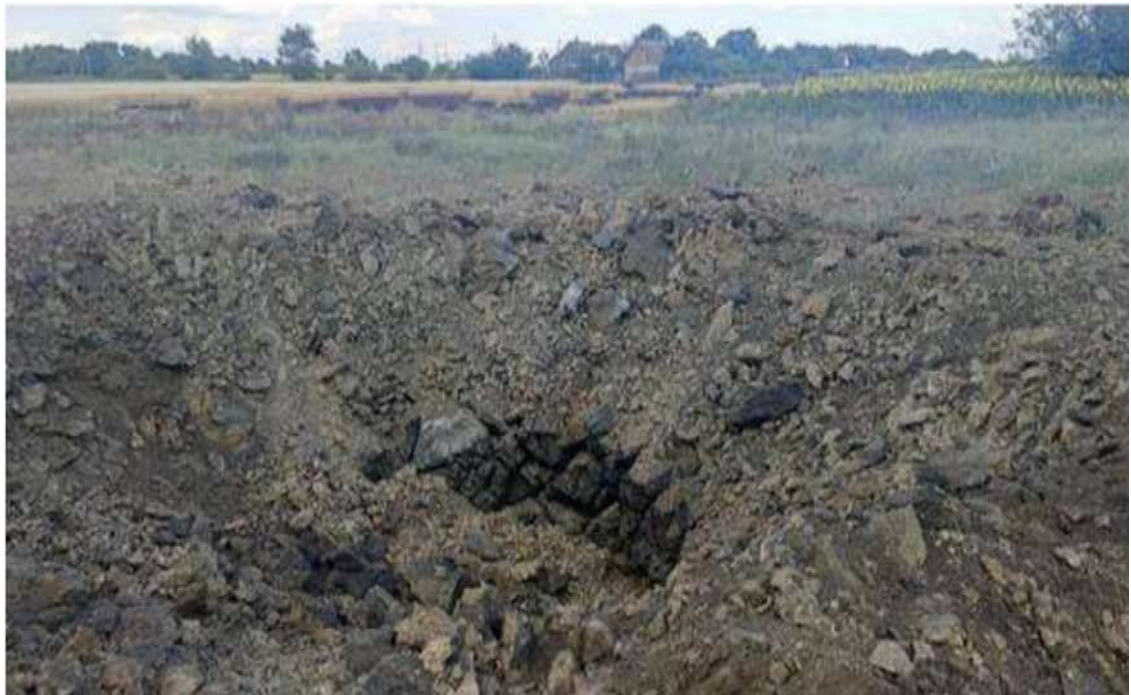
Рис. 2.7 - Блокова структура та тріщинуватість ґрунту після впливу фосфорних боєприпасів
