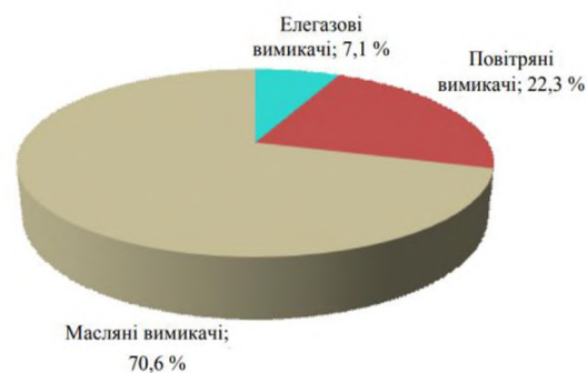
Рис.1.2. Частота відмов вимикачів різних видів
