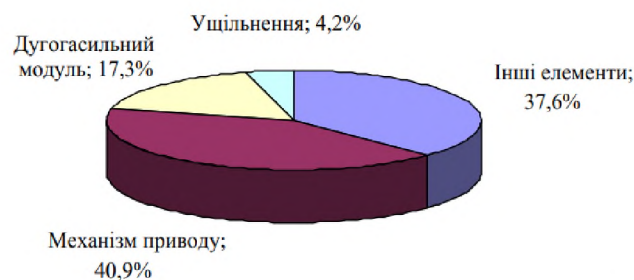
Рис. 1.4. Діаграма відмов елегазових вимикачів
