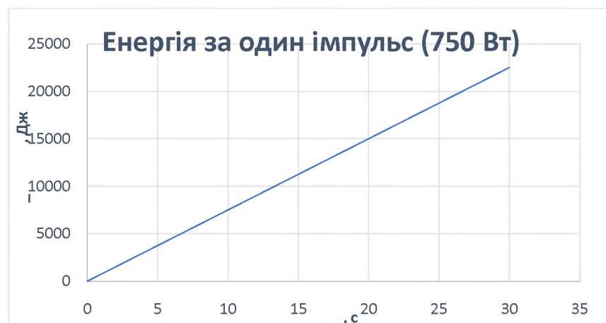
Рис. 2.31. - P_{Rave} – при різних значеннях часу тривалості імпульсу гальмування, тривалість циклу 60 с для 0.9 кВт
