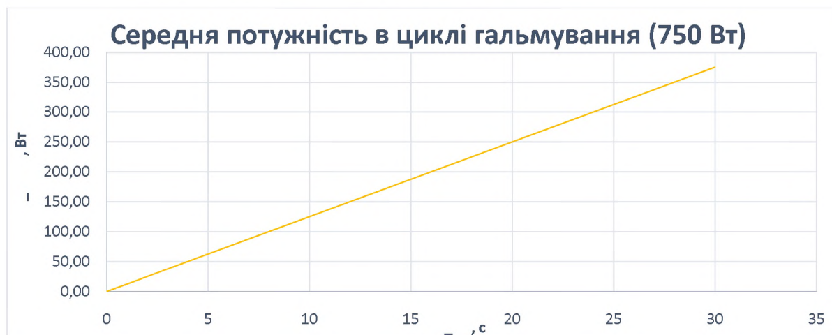
Рис. 2.33. - P_{Rave} – при різних значеннях часу тривалості імпульсу гальмування, тривалість циклу 60 с для 0.75 кВт
