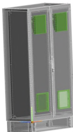
Рис. 2.14. – Зібрана модель шафи RITTAL ШВГ: 1200x2000x600 мм з фільтруючими «fan-and-filter» та «outlet filter» блоками та цоколем
