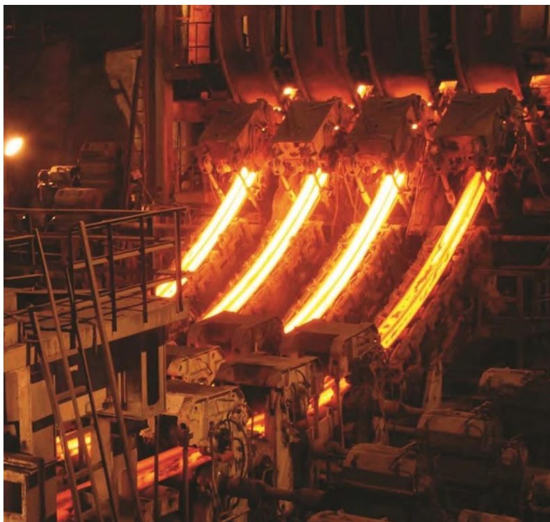
Рисунок 2.1 – Чотирирівчакова радіальна машина безперервної розливки сталі
