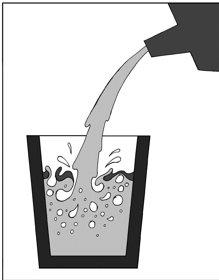
Рисунок 2 - Ежектування повітря струменем металу під час випуску плавки.
