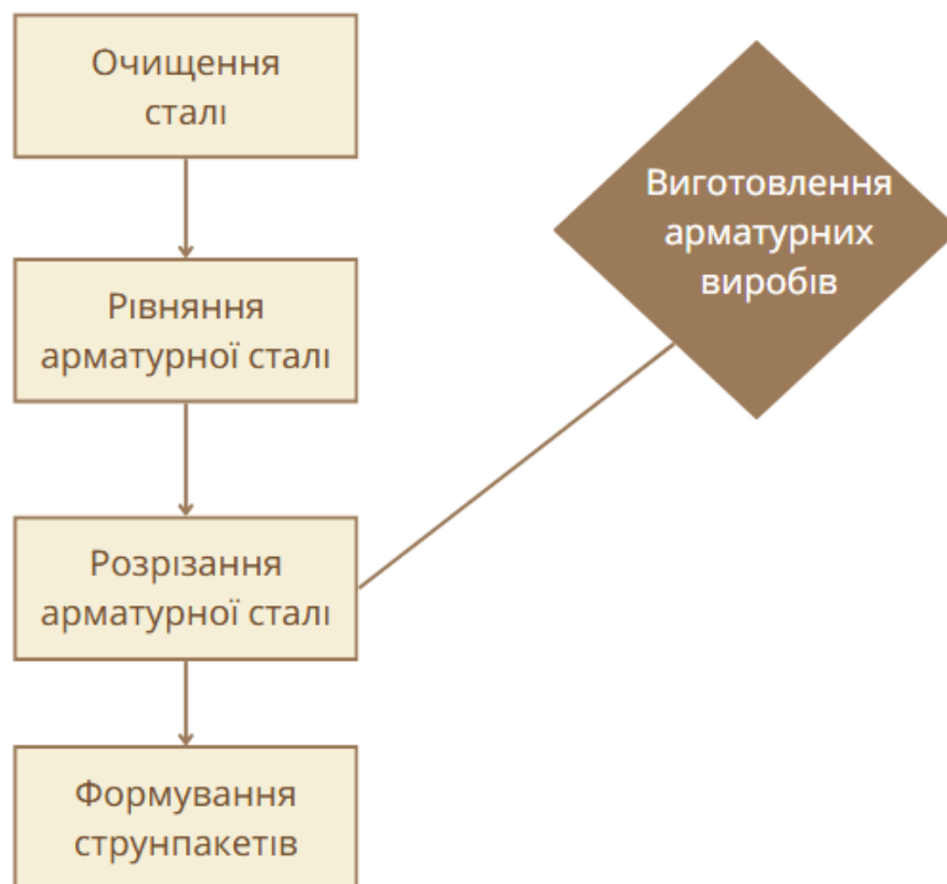
Рис. 5.1.3. Блок-схема виготовлення арматурних струнпакетів
