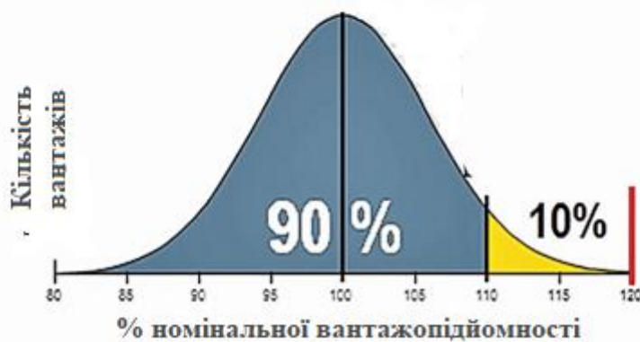
Рис.3.15. Рекомендації по завантаженню кар'єрних автосамоскидів
