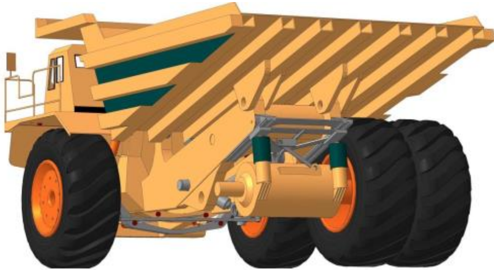
Рис.3.17. Механізм зміни центра мас на рамі автосамоскида - вид ззаду
