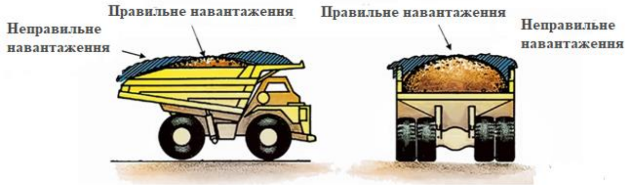
Рис.3.12. Основні правила завантаження кар'єрного автосамоскида
