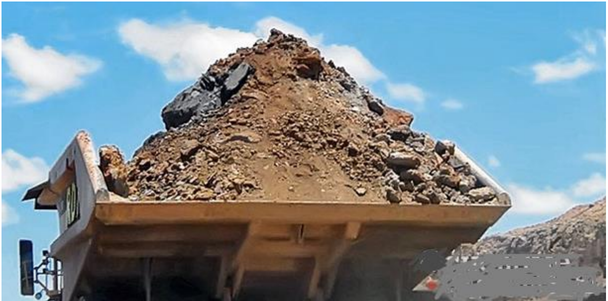
Рис.3.14. Вантаж розміщений зі зміщенням від центру
