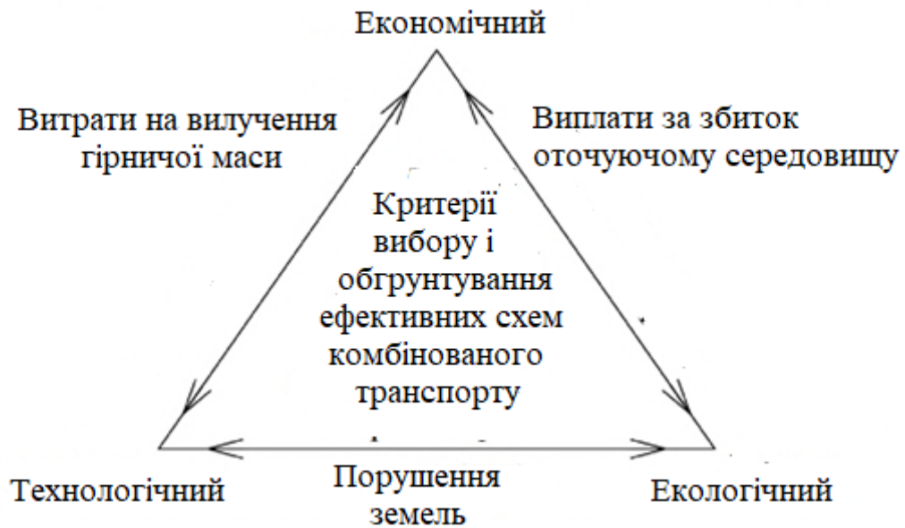
Рис.2.1. Зв'язок умов вибору схем внутрішньокар'єрного транспорту на глибоких кар'єрах
