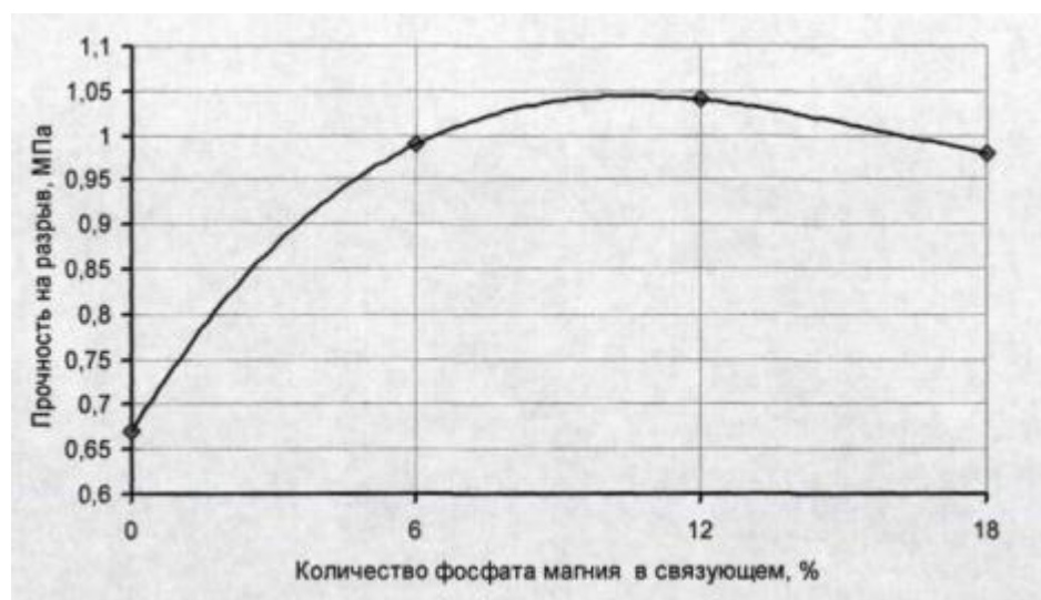
Рис. 3.24. Залежність міцності сумішей, затверджуваних при температурі 150 °C від вмісту фосфату магнію в зв'язувачім \text{MgSO}_4
