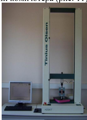
Рис. 11. Сучасна розривна машина, що застосовується для випробувань стандартних зразків на міцність
