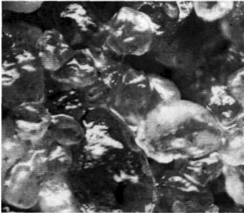
Рис. 2.3. Структура суміші піску, \text{MgSO}_4 і води: а) до затвердіння сушінням; б) після сушіння при температурі 180^\circ\text{C} . Збільшення \times 25 .
