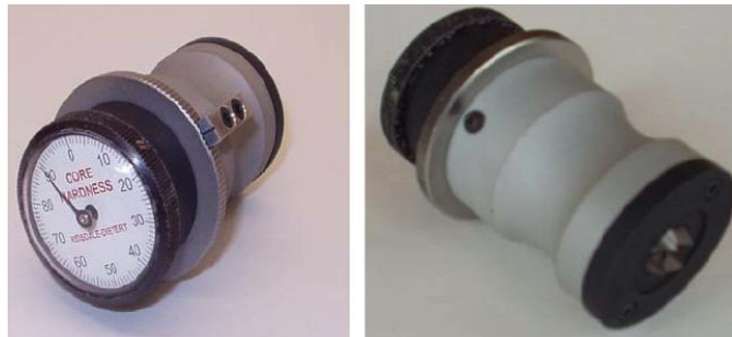
Рис. 12. Тестер для оцінки твердості стрижня дряпанням
