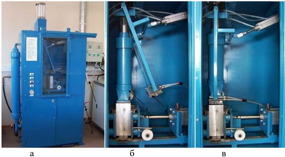
Рис. 15. Лабораторний cold-box автомат: а - загальний вигляд; б - етап надування піщаної суміші; в – етап продування аміном
