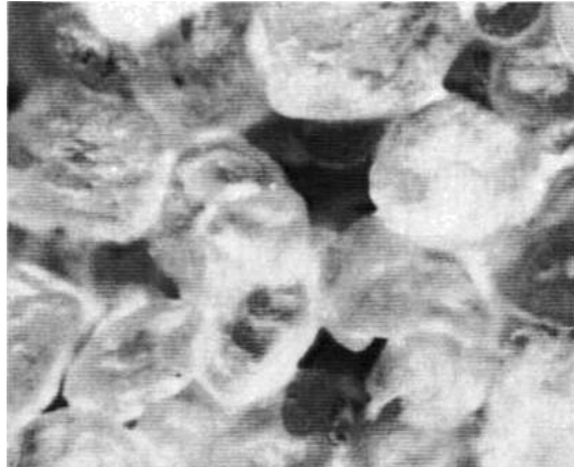
Рис. 2.3. Структура суміші піску, \text{MgSO}_4 і води: а) до затвердіння сушінням; б) після сушіння при температурі 180^\circ\text{C} . Збільшення \times 25 .
