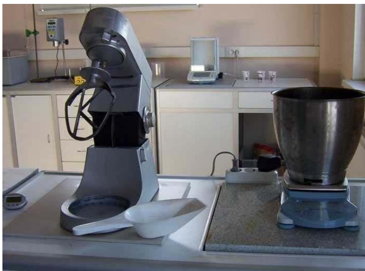
Рис. 10. Лабораторний міксер і чаша, встановлена на ваги, перед дозуванням компонентів ПСС
