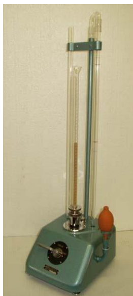
Рис. 3. Апарат для вимірювання питомої площі поверхні піску
