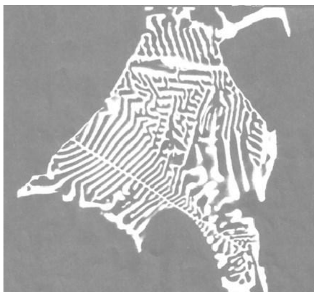
Рисунок 5.5 – Мікроструктура карбідної евтектики с карбідами (W,Fe)_6C x1000
