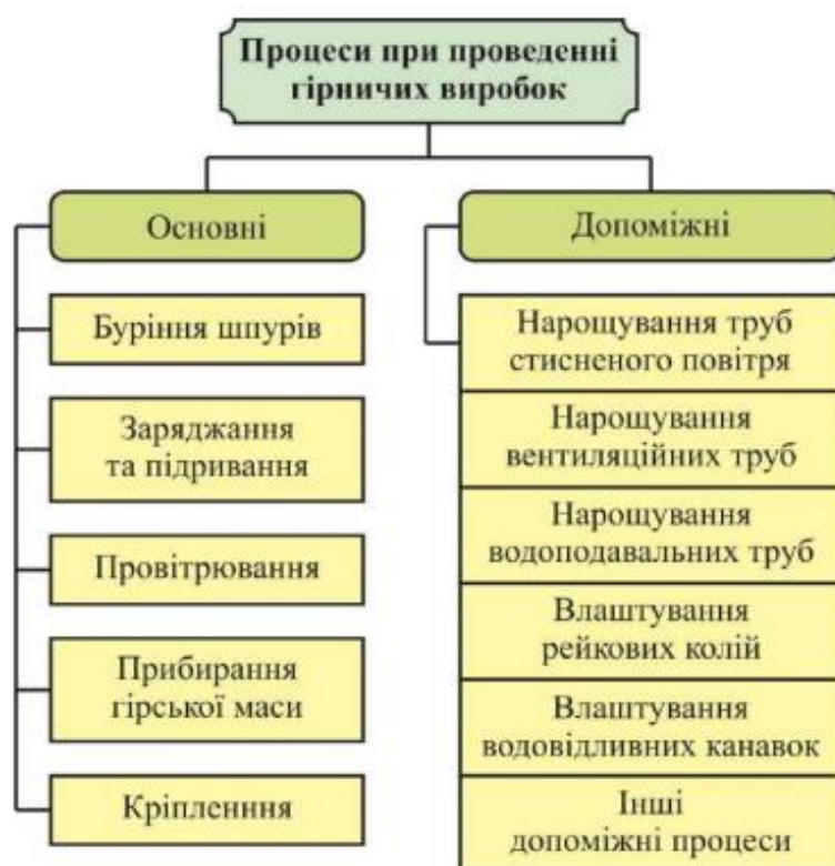
Рисунок 1.1 – Технологічні операції, що входять до складу прохідницького циклу буропідривного проведення горизонтальних підземних виробок
