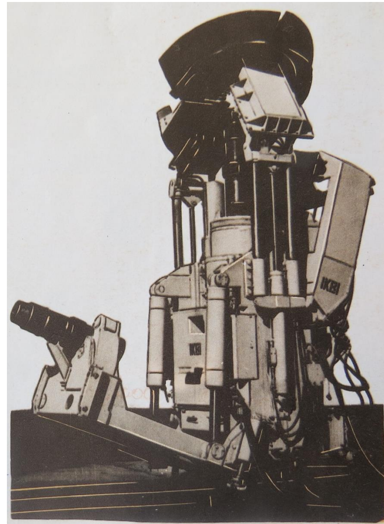
Рисунок 1.4 – Прохідницький комбайн 1KB1 розробки інституту НДПрудмаш (м. Кривий Ріг): a – принципова схема (1 – бурильний верстат; 2 – жолоб для бурового дріб'язку; 3 – робочий інструмент; 4 – центрувальний пристрій); б – зовнішній вигляд установки
