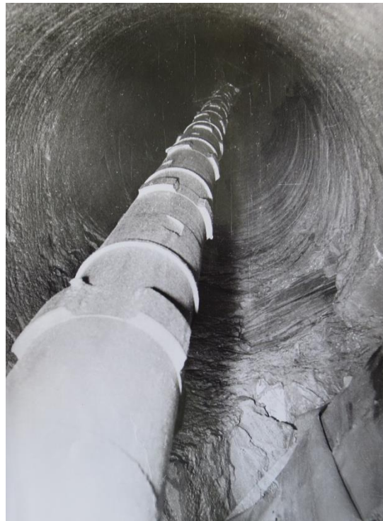
Рисунок 3.4 – Буровий постав прохідницького комбайну у висхідній виробці
