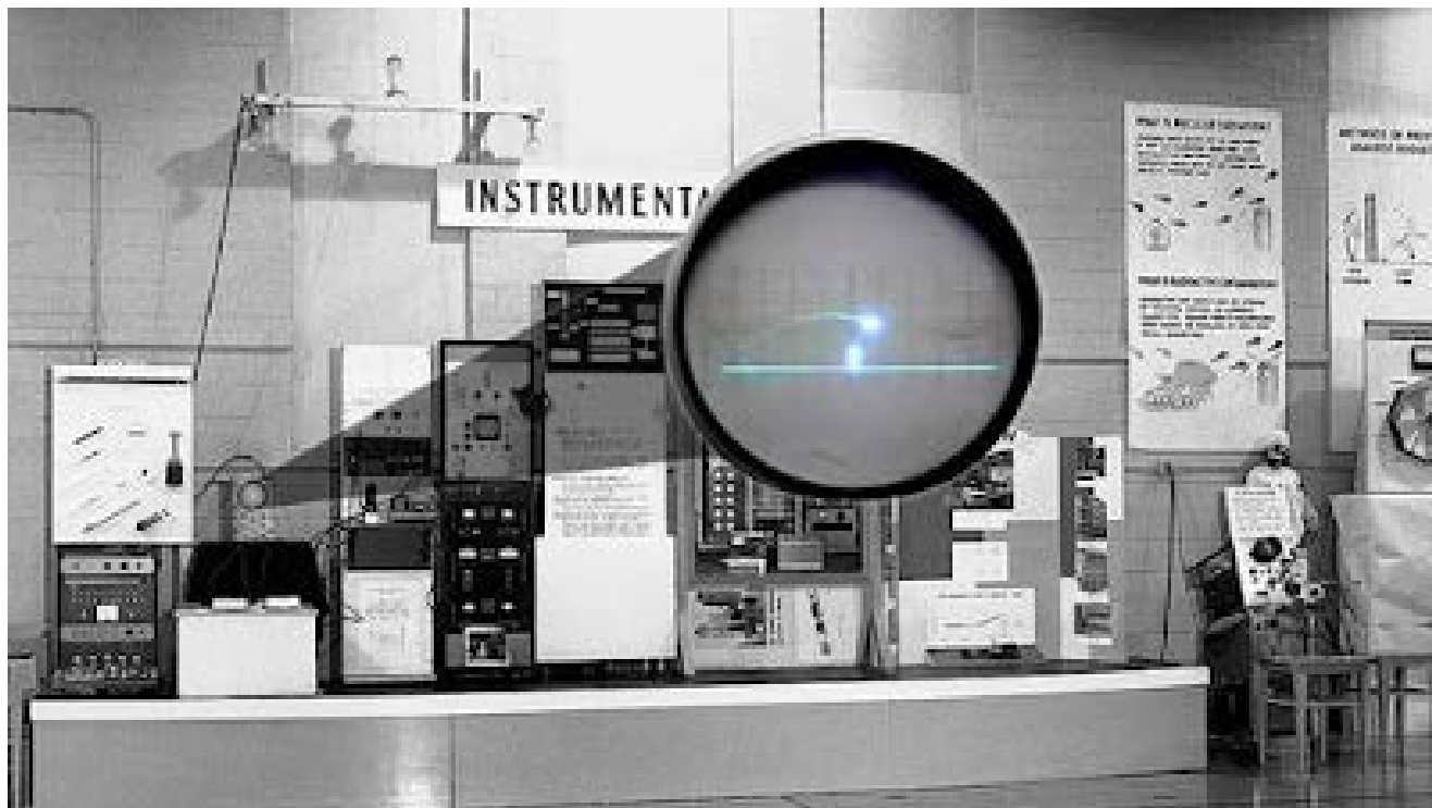
Рисунок 1.1 – Зображення електромеханічної розробки Tennis for Two
