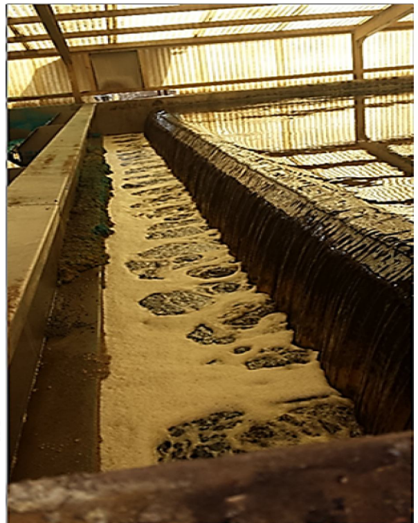
Рис. 1.5. Ліворуч – блок-схема етапів та процесів видобутку металу з рудного родовища (Джерело: Ridley, J. (2013) “What is an ore deposit?”, in Ore Deposit Geology. Cambridge: Cambridge University Press). Праворуч – переробка мідної руди методом флотації, Кіпр (Photo : Jonathan Hamisi)
