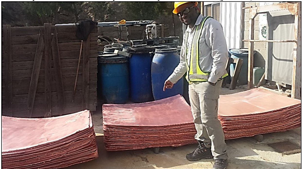
Рис. 1.2. Мідний катод із вмістом міді майже 99,995% металу Cu (Photo : Jonathan Hamisi)
