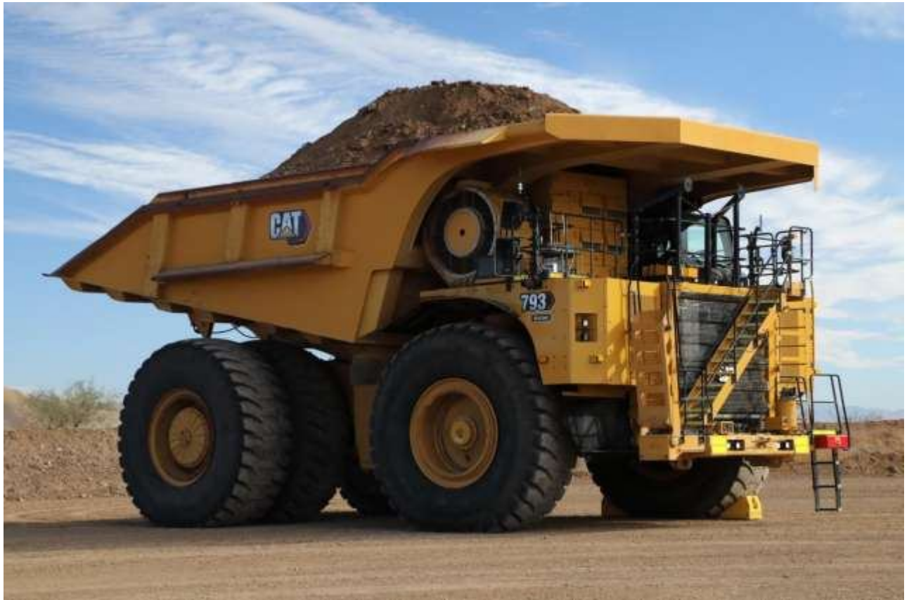
Рис. 3.7. Електричний кар'єрний самоскид Cat-793 (вантажопідйомність – 265 т., максимальна швидкість – 60 км/год, рекуперативне гальмування) (Джерело: SpecMachinery.com.ua,)
