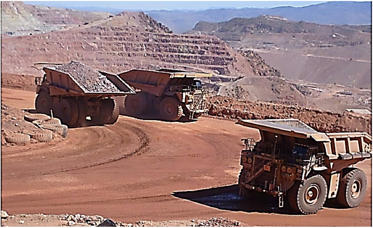
3.16. Майданчик Фріпорт-Макморан, США. Невдало спроектований крутий поворот [Джерело: https://www.deswik.com/api/PublicMedia/3a9a2a8e-0807-465c-ae25-08dd9800125b/download/Document/99f316d3-0069-45bc-6da8-08dd980005b2 [72]
