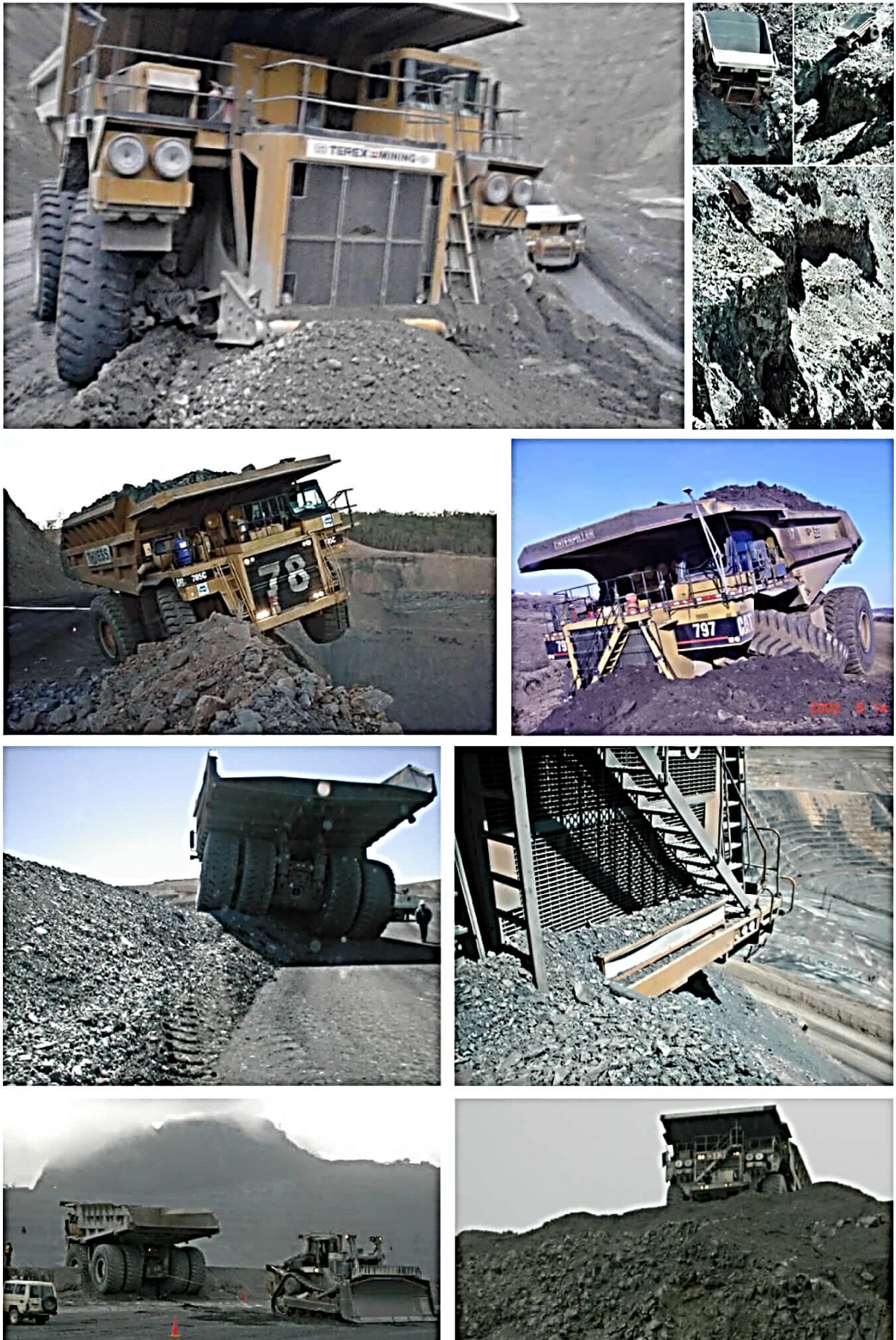
Рис. 3.16. Для чого в кар'єрі влаштовують запобіжні валки [Джерело: https://www.deswik.com/api/PublicMedia/99acad95-1368-48e8-ae23-08dd9800125b/download/Document/29235b13-7c51-45bb-6da6-08dd980005b2 [69]
