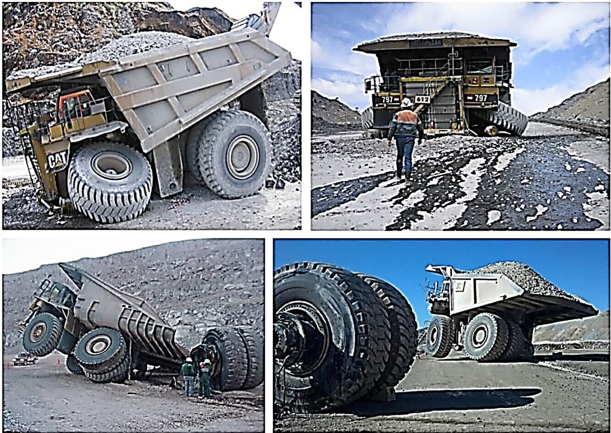
Рис. 3.17. Пошкодження вантажівки через погану конструкцію рампи, що створює навантаження на рульову раму та осі [Джерело: https://www.deswik.com/api/PublicMedia/026a3d94-60a6-4d54-ae24-08dd9800125b/download/Document/84634515-53f2-438c-6da7-08dd980005b2 [70]]
