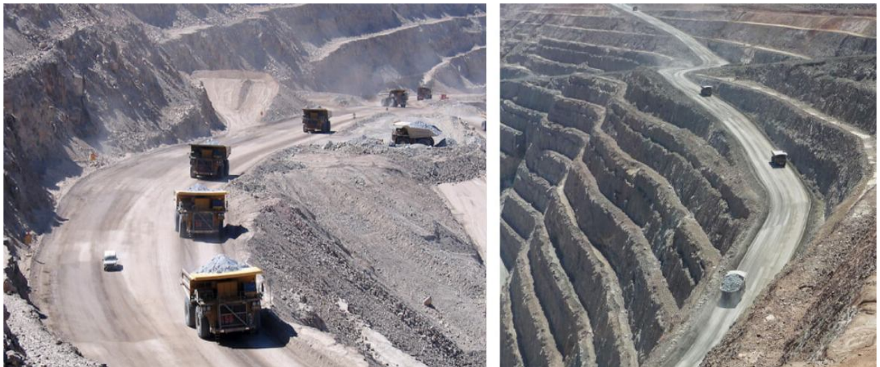
Рис. 3.15. Лівосторонній завантажений кар'єрний спуск. Це – менш бажане розташування (але його можна уникнути через серпантини). Ліворуч: Чукікамата (Chuquicamata). Праворуч: Супер-кар'єр Калгурлі (Kalgoorlie) [Джерело: https://www.deswik.com/api/PublicMedia/4e5005f1-f607-409d-ae26-08dd9800125b/download/Document/3f17484b-8c83-4b86-6da9-08dd980005b2 [71]]
