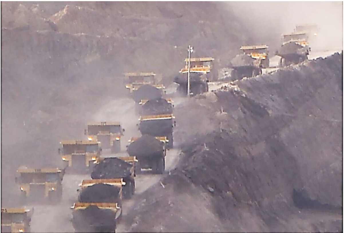
Рис. 3.17. Правий бічний завантажений кар'єрний спуск. Це – найменш бажане (найменш безпечне) розташування його на краю кар'єрної порожнини [Джерело: https://www.deswik.com/api/PublicMedia/2e0bdb23-3c21-44ae-ae27-08dd9800125b/download/Document/7bb78738-c85b-4d53-6daa-08dd980005b2 [73]
