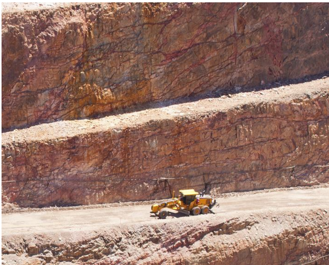
Рис. 3.15. Транспортні берми (вище) та з'їзди (знизу) на бортах глибоких кар'єрів [46]
