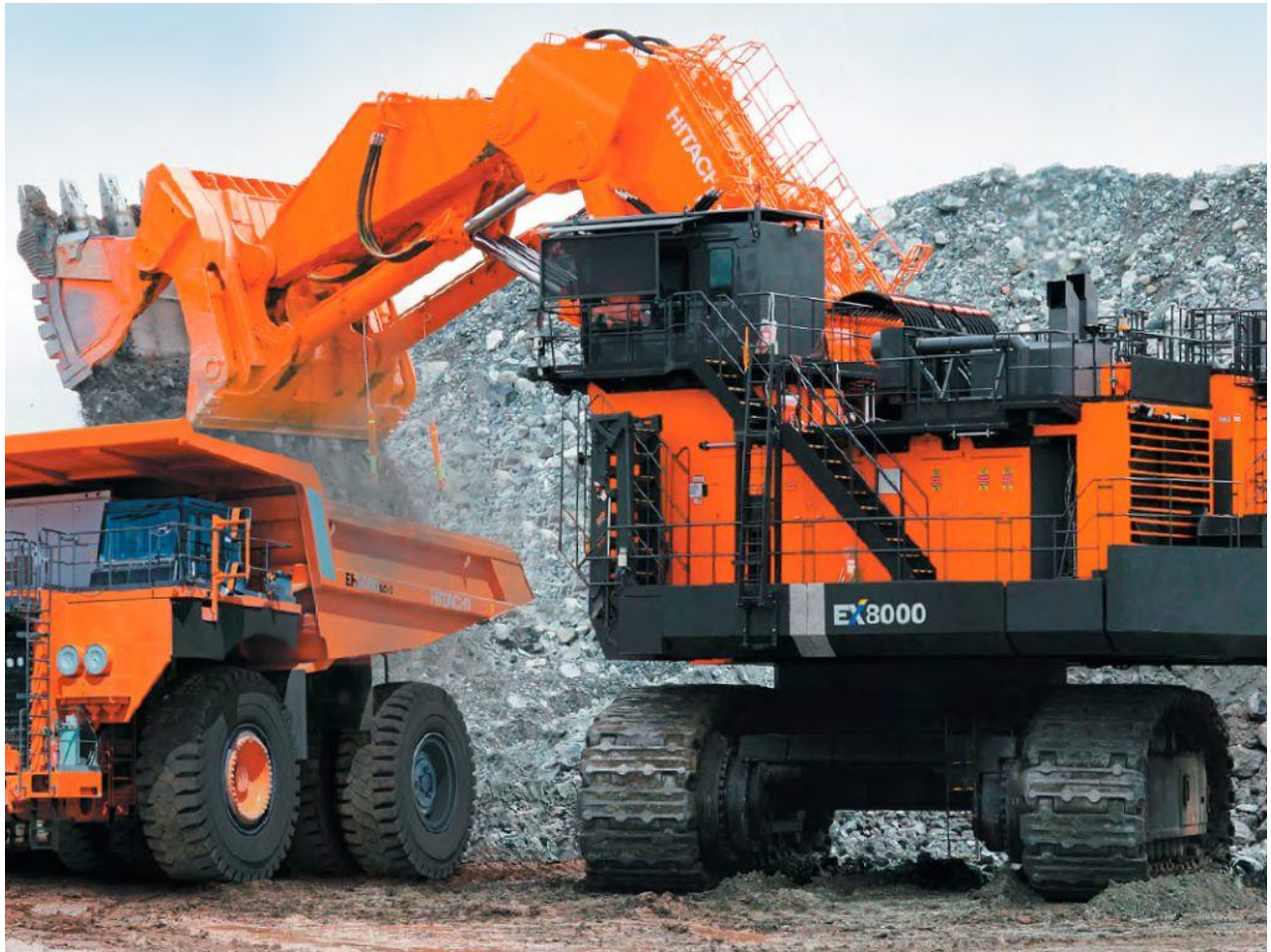
Рис. 1.6. Гідравлічний екскаватор Hitachi EX8000-6: маса – 837 т, ємність ковша – 43 м 3 , ловжина рукояті – 5,8 м, максимальна глибина копання – 8,4 м, максимальна робоча висота – 19,0 м, максимальний радіус копання – 22,3 м, максимальна висота вивантаження – 11,9 м (Джерело: https://www.hitachicm.ua/produkcija/ekskavatory/gornye-ekskavatory/ex8000-6/ [29])
