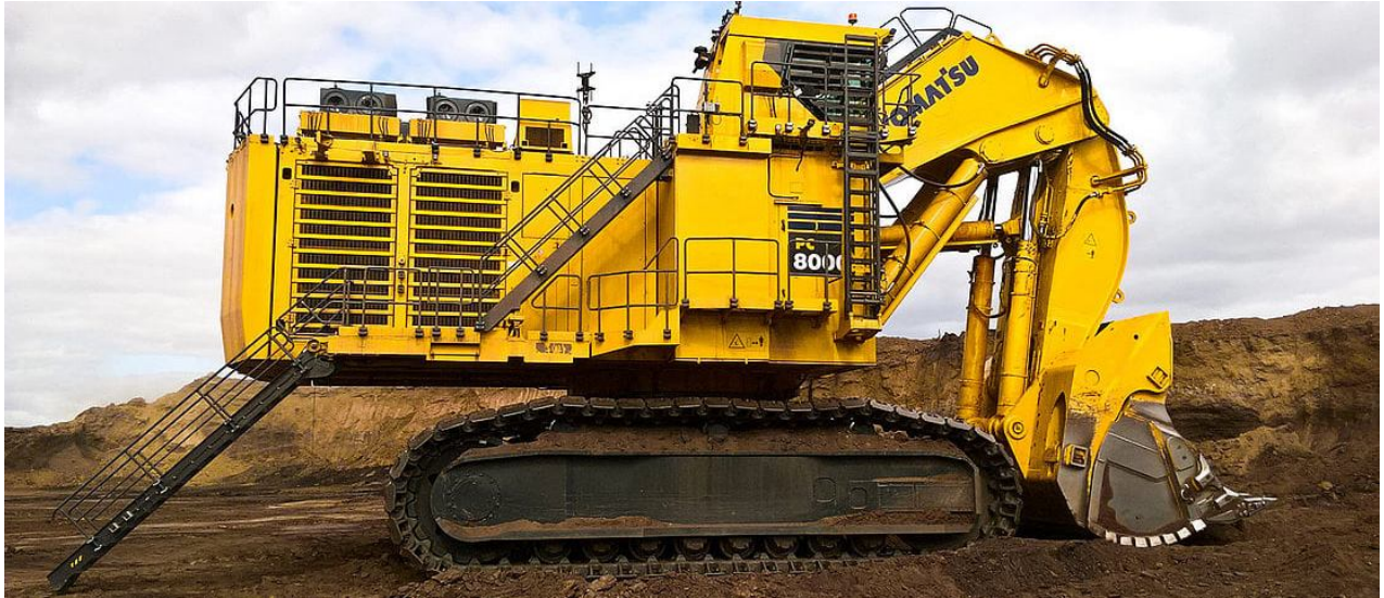
Рис. 1.4. Гідравлічний екскаватор Komatsu PC8000-6: маса – 777 т, ємність ковша – 42 м 3 , довжина – 14,08 м, ширина – 10,01 м, висота – 9,65 м, макс, досяжність по горизонталі – 20,7 м, глибина черпання – 8 м (Джерело: https://www.lectura-specs.com.ua/ua/model/budivel-na-tehnika/gusenichni-eks-kavatori-komatsu/pc8000-6-11731058 [27])
