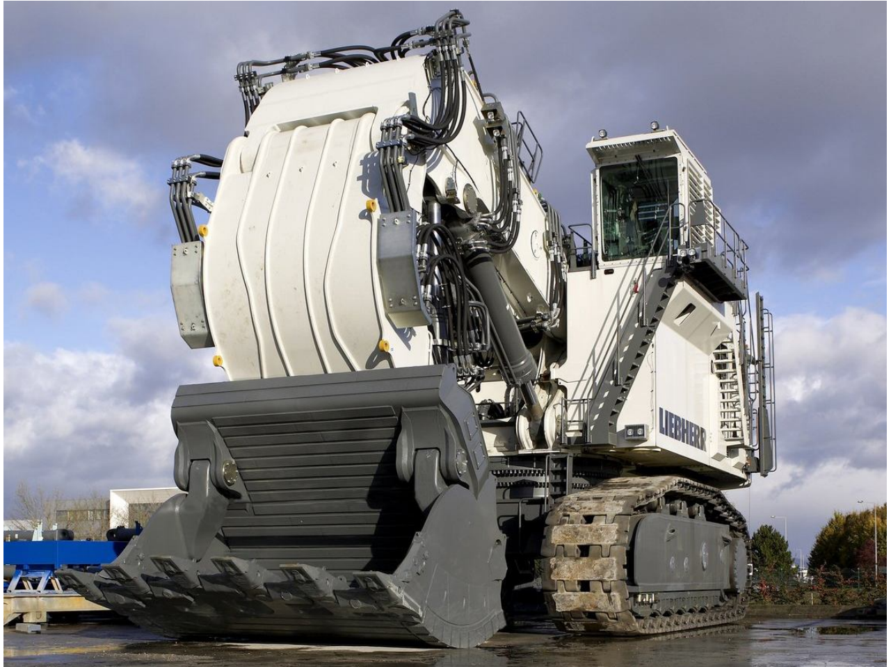
Рис. 1.3. Гідравлічний екскаватор Liebherr R 9800: маса – 800 т, ємність ковша – 42 м 3 , ширина доріжки – 16,3 м, макс. досяжність по горизонталі – 20.1 м, глибина черпання – 9 м. (Джерело: https://www.olx.ua/uk/transport/spetstechnika/ekskavatory/q-liebherr [26])
