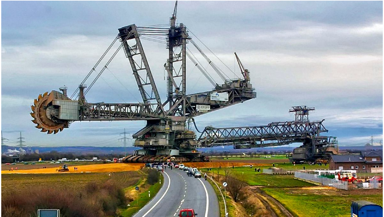
Рис. 1.1. Роторний екскаватор Bagger 293 німецької компанії TAKRAF (1995р.) – найбільша самохідна машина у світі: довжина – 225 м, висота – 96 м, маса – 14 200 т; ротор, діаметром 23 м, має 20 ковшів по 15 м 3 ; екіпаж – 5 операторів (Джерело: https://uk.wikipedia.org/wiki/Bagger_293 [24])
