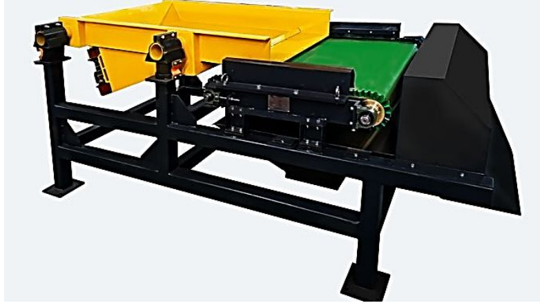
Рис. 2.19. Експериментальний магнітний конвеєр (Джерело: [24])
