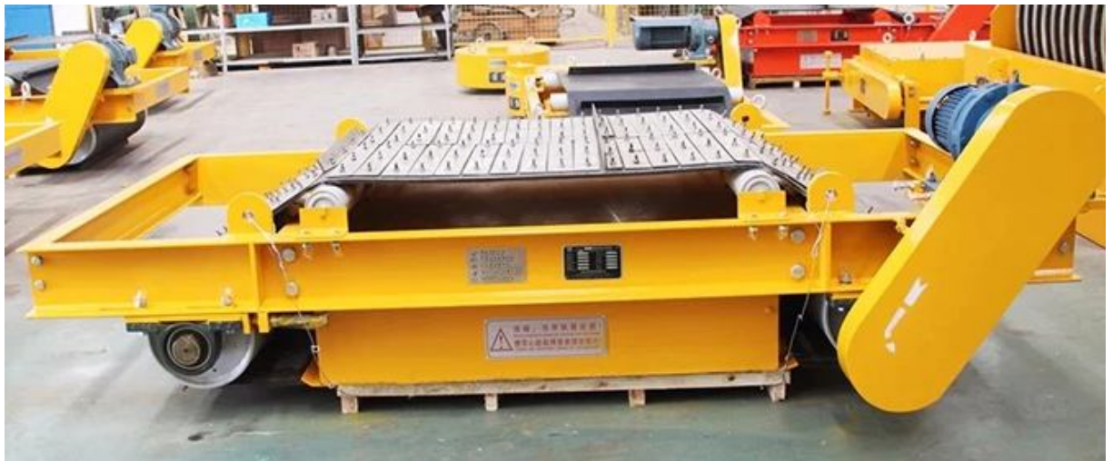
Рис. 2.1. Магнітний сепаратор LIMS-типу
