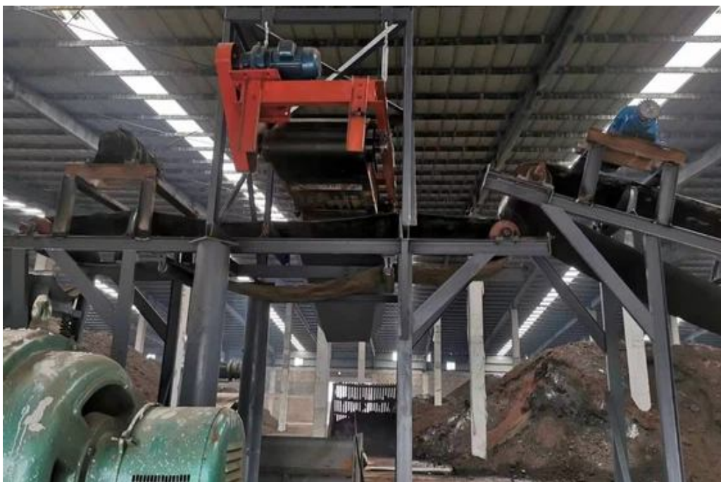
Рис. 1.11. Експериментально-промислова лінія магнітного розділення руди (Джерело: https://fr.gme-magnet.com/info/magnetic-separation-in-mineral-processing-17105077363631104.html )
