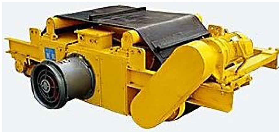
Рис. 2.27. Вентиляторний електромагнітний сепаратор (Джерело: [24])
