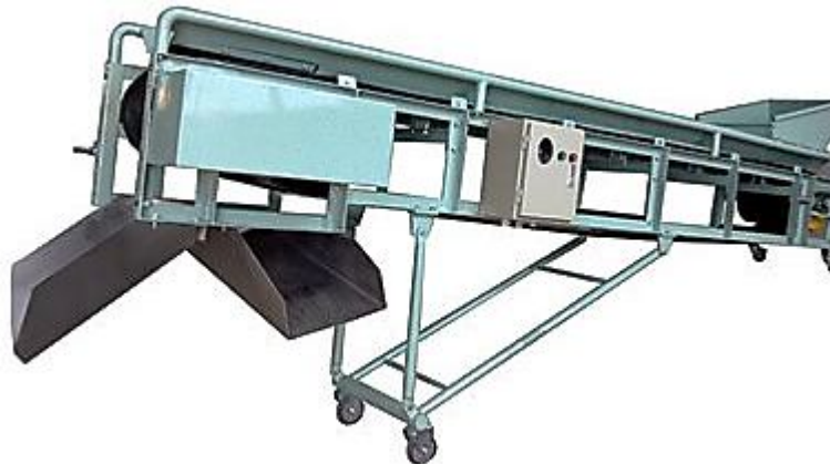
Рис. 2.41. Магнітна сепараторна стрічка (Джерело: [24])
