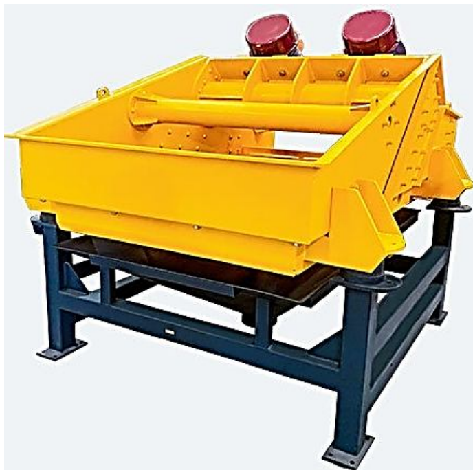
Рис. 2.36. Лінійний вібраційний екран для зневоднення (Джерело: [24])
