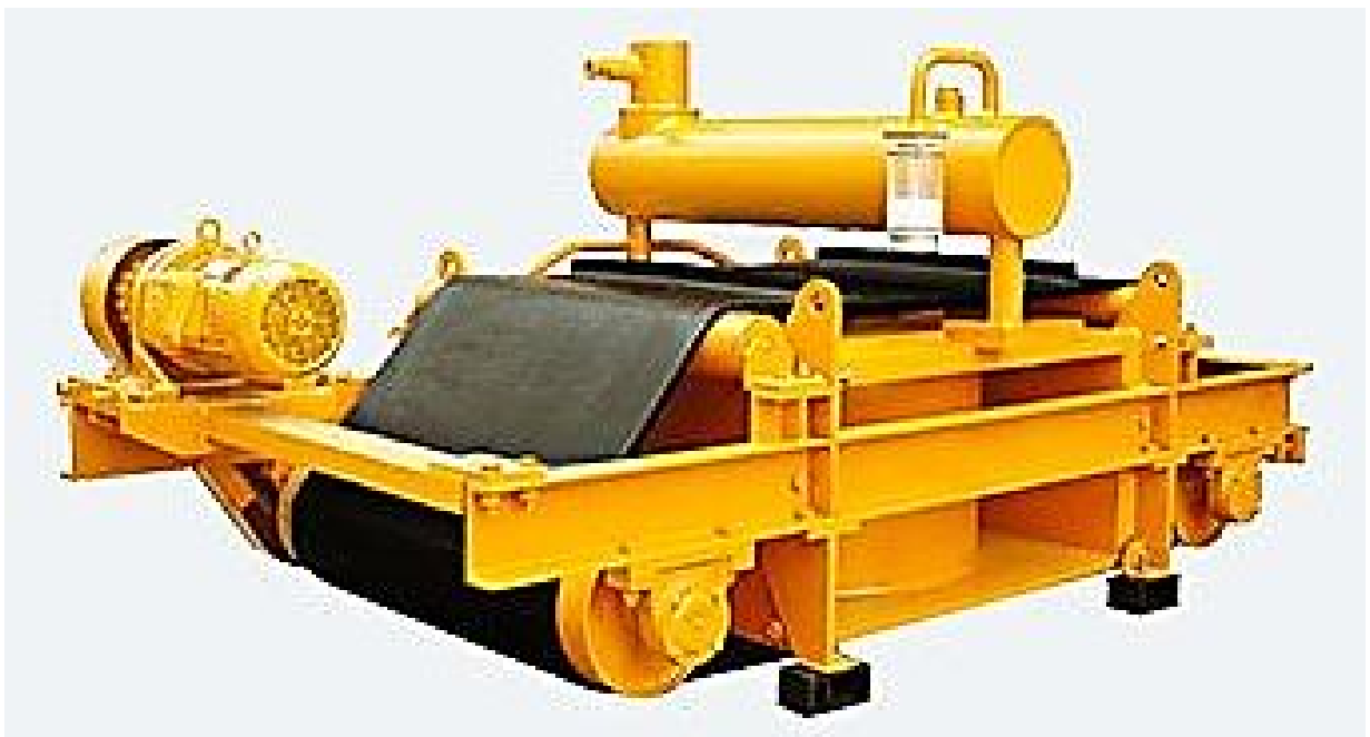
Рис. 2.20. Пластинчастий затворний магніт (Джерело: [24])
