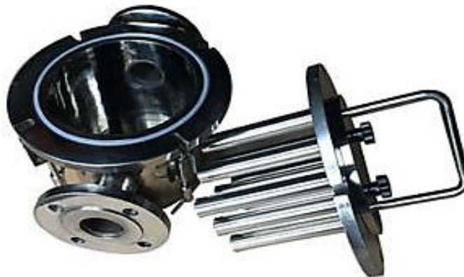
Рис. 2.13. Магнітний рідинний пристрій (Джерело: [23])
