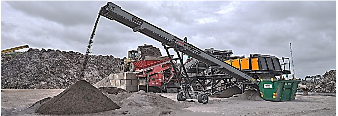
Рис. 4.6. Комплекс магнітного сортування фракцій компанії Norditek [54]
