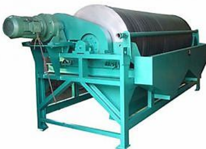
Рис, 2.8. CTS Мокрий барабанний магнітний сепаратор (Джерело: [23])
