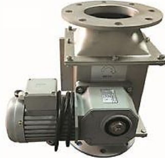
Рис. 2.12. Обертовий решітчастий магніт (Джерело: [23])
