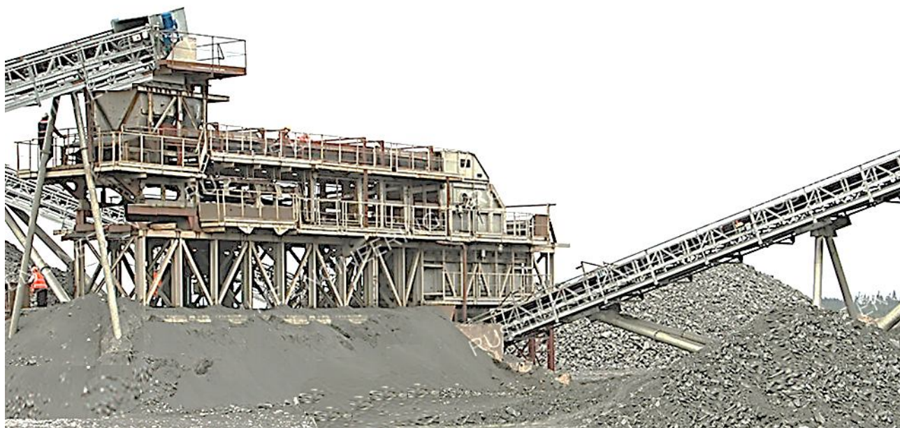
Рис. 4.4. Передаточний вузол комплексу механізованої магнітної рудорозбірки КМР [52]
