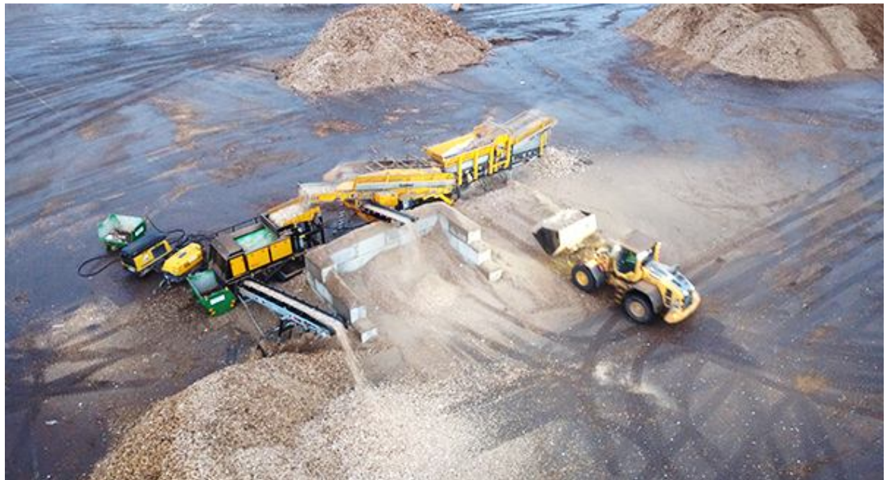
Рис. 4.7. Комплекс магнітного сортування мінеральної сировини Norditek [Джерело: https://norditek.se/de/energieerueckgewinnung/ [55]]
