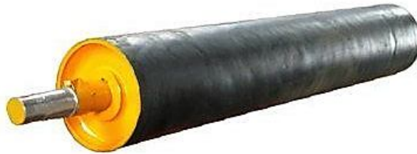
Рис. 2.40. Магнітний шків (Джерело: [24])
