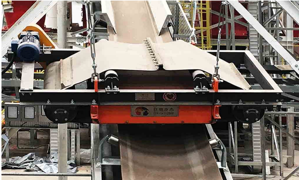
Рис. 2.17. Постійний надстрічковий магніт (Джерело: [24])
