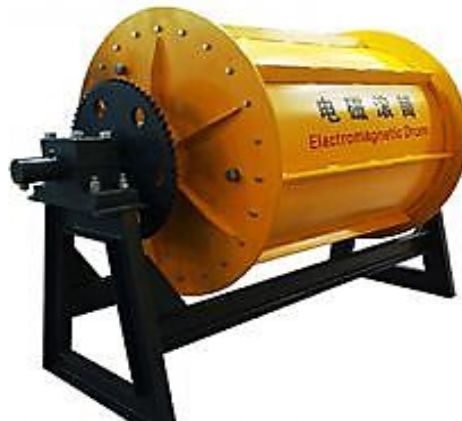
Рис. 2.10. Електробарабанний магніт (Джерело: [23])
