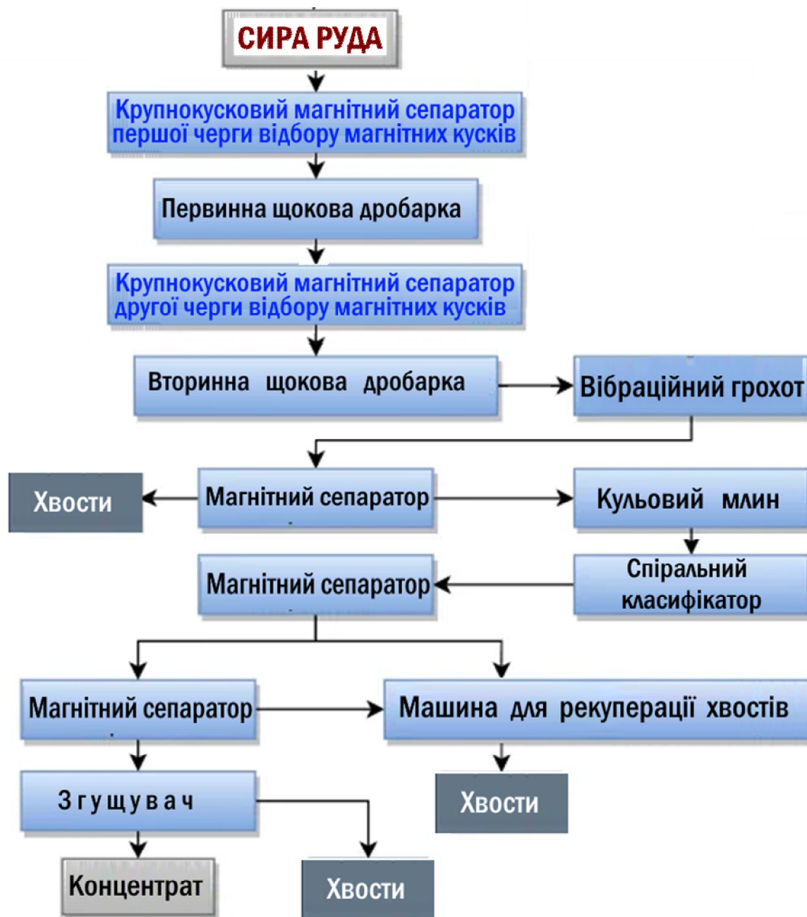
Рис. 4.15. Пропонована схема внутрішньокар'єрної крупнокускової магнітної сепарації за умов застосування пересувних дробарок та конвеєрів
