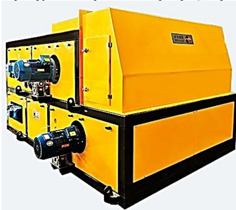
Рис. 2.32. Двопрохідний сепаратор вихрових струмів (Джерело: [24])
