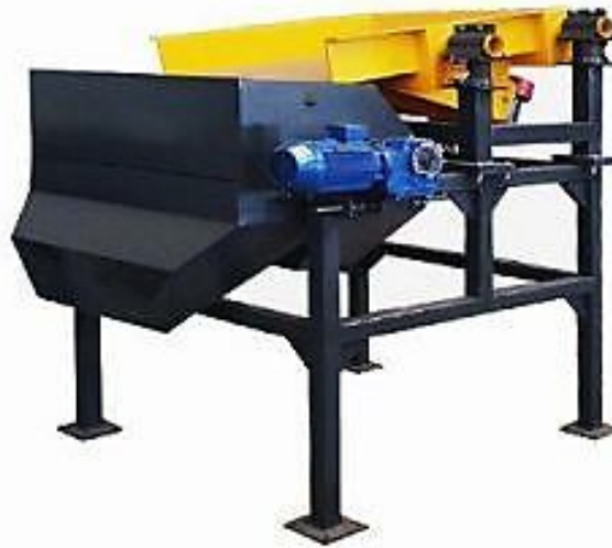
Рис. 2.9. Постійний барабанний магніт (Джерело: [23])
