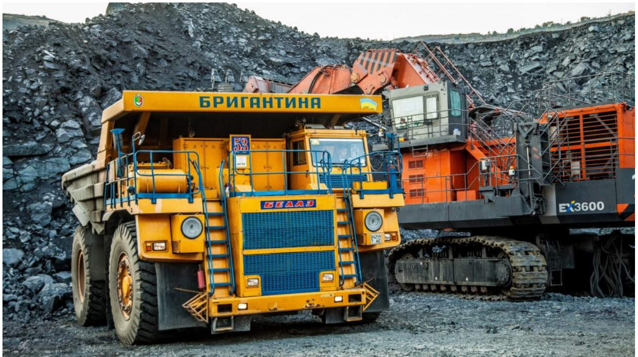
Рис. 3.8. Екскаваторно-автомобільний комплекс кар'єру «ПівдГЗК» (Джерело: https://www.ugok.com.ua/about/structure.php?lang=ua [43])
