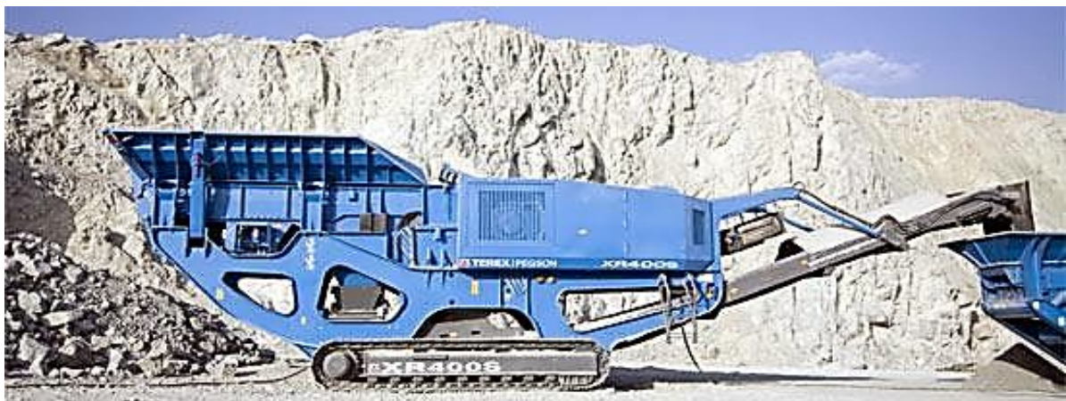
Зрис. 4.25. Мобільна щокова дробарка TerexPegsonXR400: 5 000 м/год; потужність 230 к.с. (169 кВт); паливе – дизель; мобільна; гусеничний хід; продуктивність 290 т/год. [Джерело: https://www.veritread.com/specs/asphalt-paving-compaction-crushing/crushers/powerscreen/xr400 [83]
