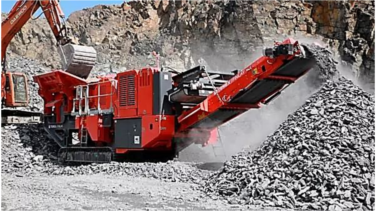
Рис. 4.26. Мобільна щоква дробарка Terex Finlay J-1175: 4 700 м/год; потужність 350 к.с. (257 кВт); паливе – дизель; мобільна; гусеничний хід; об'єм бункера 9 м 3 ; продуктивність 275 т/год. [Джерело: https://dptrans.com.ua/arenda-drobilki/tereh-finlay-j-1175/ [84]
