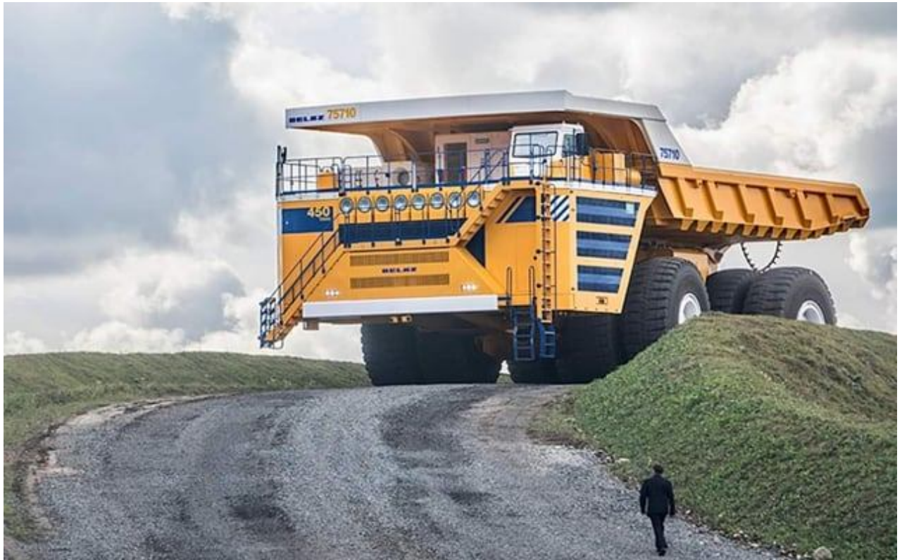
Рис. 4.23. БелАЗ-75710 – найбільший у світі кар'єрний самоскид вантажо-підйомністю 450 тон [Джерело: https://encrypted-tbn0.gstatic.com/images?q=tbn:ANd9GcQgmpt6nZEeoM9_GdOz34L0fNv4kJ0H_fsDl&as [81]
