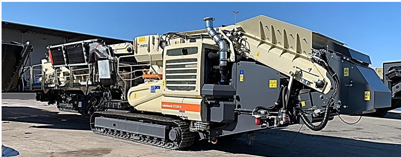
Рис. 4.28. Мобільна щоква дробарка MetsoLokotrack LT-120: 14 000 м/год; потужність 350 к.с. (257 кВт); паливе – дизель; мобільна; гусеничний хід; об'єм бункер 12 м 3 ; продуктивність 400 т/год. [Джерело: https://www.tradeearthmovers.com.au/detail/metso-lokotrack%C2%AE-lt120-mobile-jaw-crusher-870518 [86]
