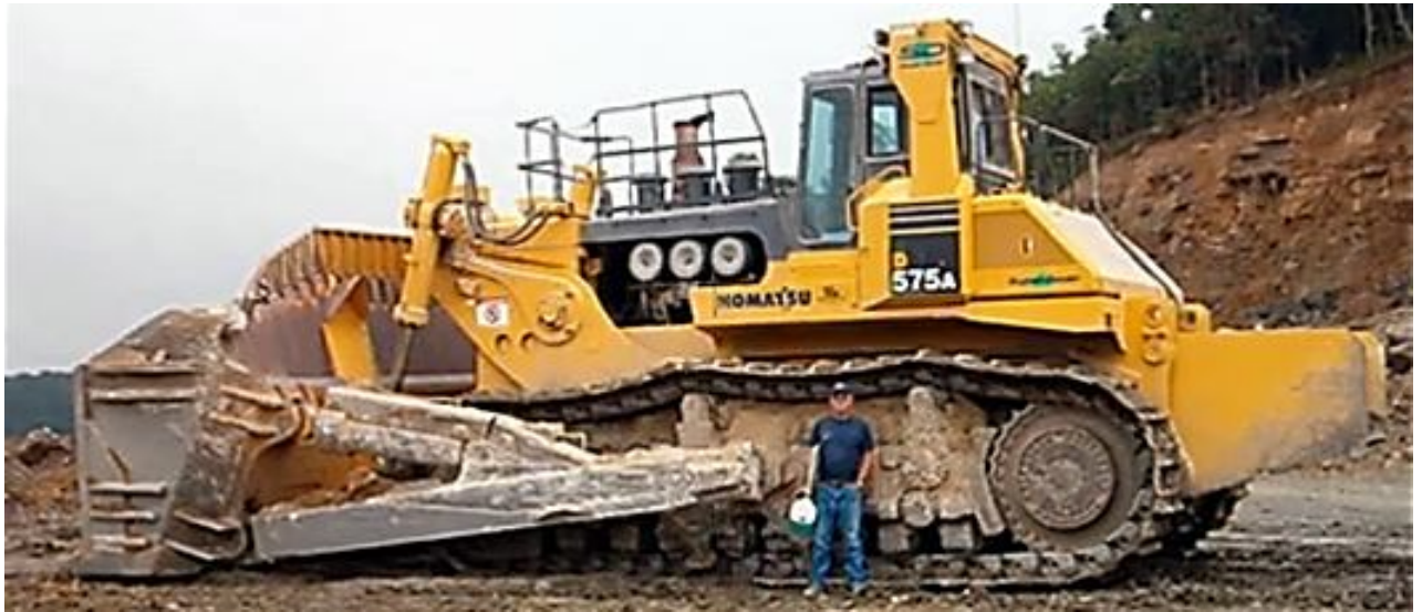
Рис. 4.19. Самий більший в світі серійний бульдозер Komatsu D575A-3SD: маса – 153 т, довжина – 12,7 м, потужність – 1000 к.с.[Джерело: https://i.ytimg.com/vi/XvwbWZDhMNc/hq720.jpg?sqp=-oaymwEhCK4FEIIDSFryq4qpAxMIARUAAAAAGAEIAADIQj0AgKJD&rs=AOOn4CLCi56ZriObGVeLm5IMy_0bf-Hun_A [77]
