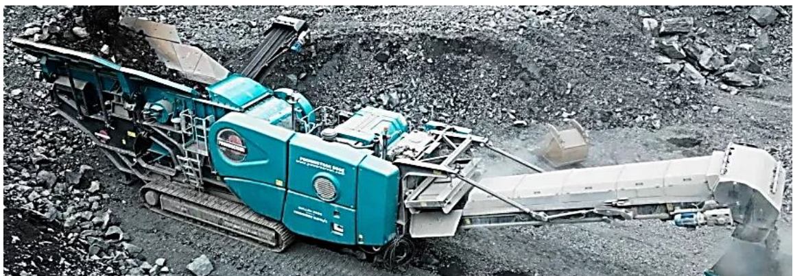
Рис. 4.24. Мобільна щокова дробарка PowerscreenPremiertrak 600E (PT600E): 12 400 м/год; потужність 275 к.с. (202 кВт); паливе – дизель; мобільна; гусеничний хід; об'єм бункера 10 м³; продуктивність – 300 т/год. [Джерело: https://www.agg-net.com/news/powerscreen-premiertrak-600e-for-collen-bros [82]
