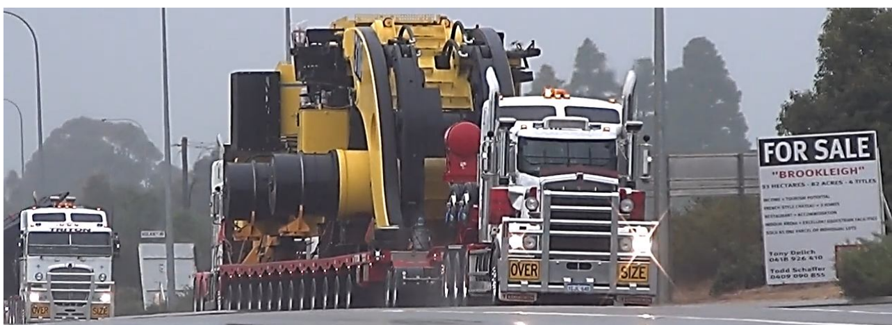
Рис. 4.18, Найбільший у світі пневмоколісний навантажувач LeTourneau L2350 (ківш – 70,2 т); знизу – його перевезення до рудника [Джерело: https://www.youtube.com/watch?v=17qddbrMfbU [76]]
