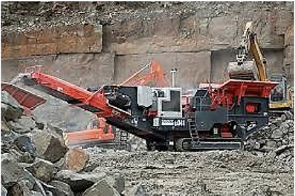
Рис. 4.27. Мобільна щоква дробарка Sandvik QJ-341: 9 800 м/год; потужність 230 к.с. (169 кВт); паливе – дизель; мобільна; гусеничний хід; об'єм бункера 10 м 3 ; продуктивність 300 т/год. [Джерело: https://encrypted-tbn0.gstatic.com/images?q=tbn:ANd9GcQMVnpedrsd1C5jKcZ17Btq-zhDJnhoHCbWPQ&s [85]
