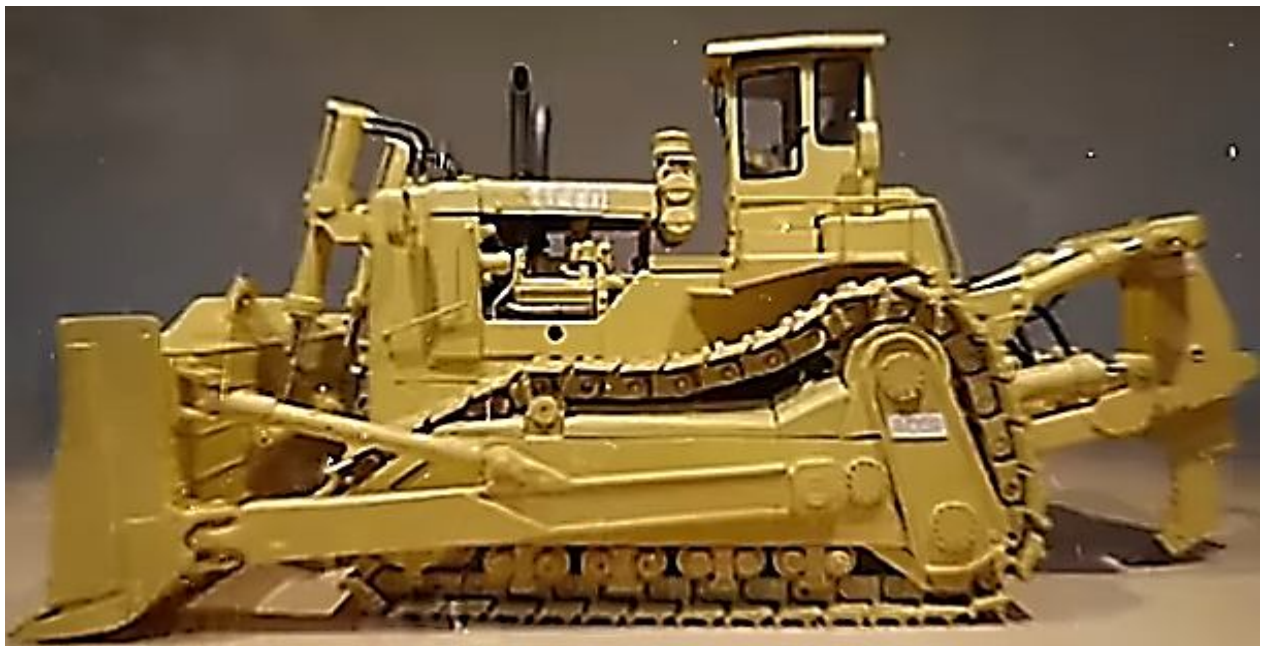
Рис. 4.20. Самий більший в світі бульдозер одиничного виготовлення ACCOSUPERDOZER (Італія): маса – 183 т, довжина – 12 м, потужність – 1350 к.с.[Джерело: https://www.sibo.eu/en/acco-super-dozer/ [78]
