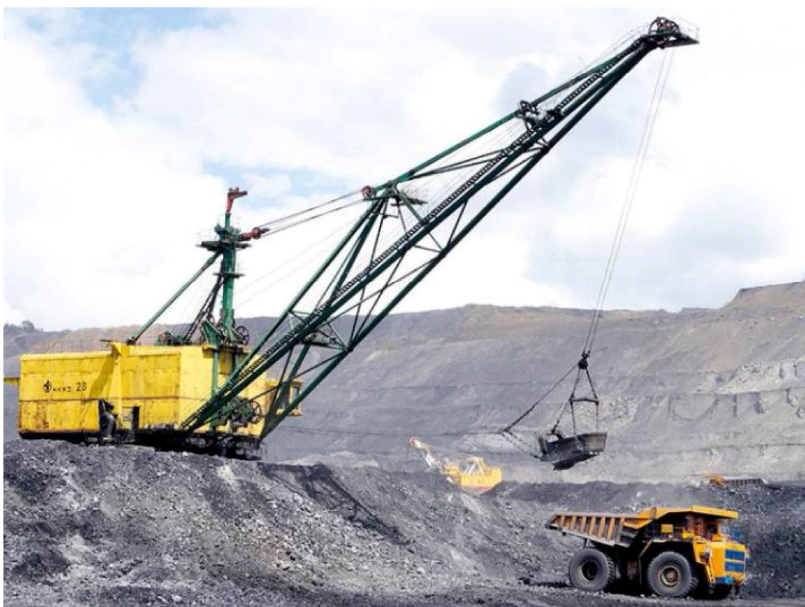
Рис. 1.2. Екскавація розкривних порід за допомогою драглайнів
