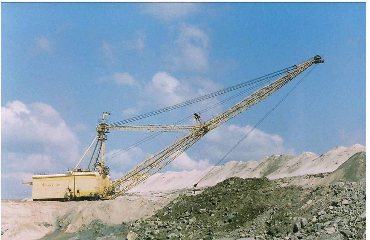
Рис. 1.1. Розробка скельного розкритву драглайнами ЕШ-10/70 (а) та ЕШ-15/90(б)
