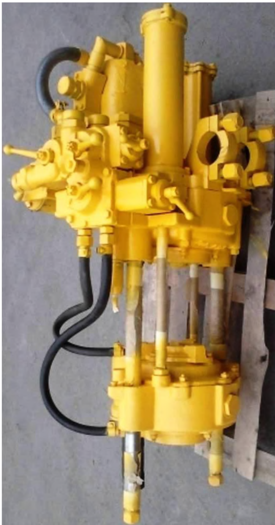
Рисунок 1.2 – Буровий станок НКР-100М
