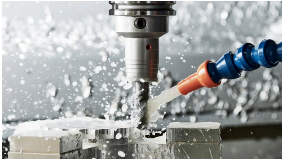
Рисунок 7.11 - Подача охолодної рідини в робочу зону
