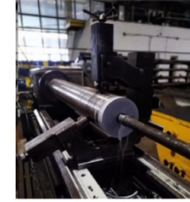
Глибоке свердління з використанням підтримувачів пристосувань
