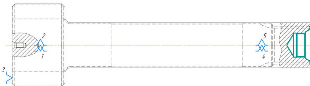
Рисунок 3.9 – Теоретичне базування операції 045
