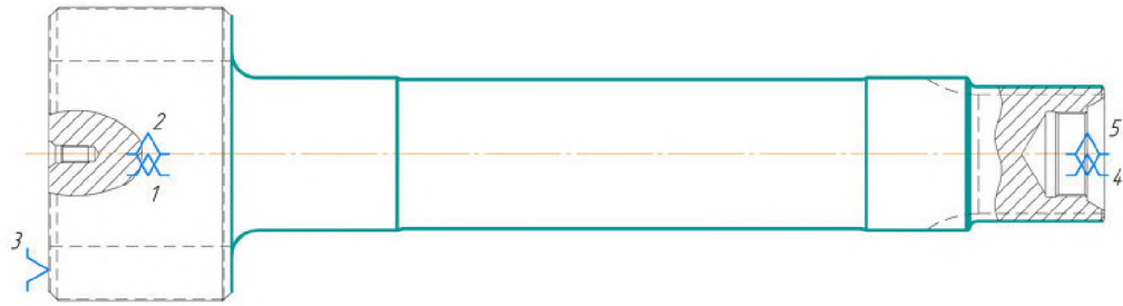
Рисунок 3.10 – Теоретичне базування операції 050
