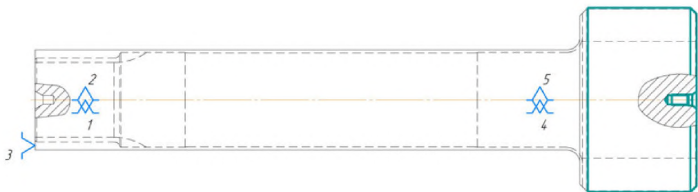
Рисунок 3.8 – Теоретичне базування операції 040
