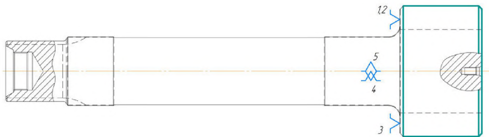
Рисунок 3.11 – Теоретичне базування операції 055
