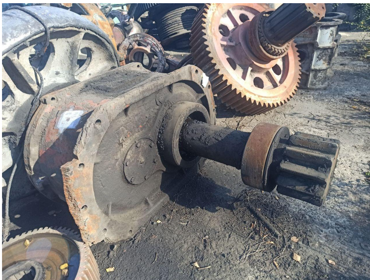
Рисунок 1.3 – Вал-шестерня редуктора повороту екскаватора ЕКГ-5А-У
