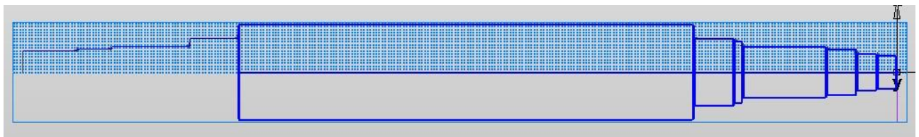
Рисунок 4.5 – Створюємо криву для точіння на першому установі
