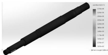
Модель із розрахованими напругами у матеріалі сталь 45
