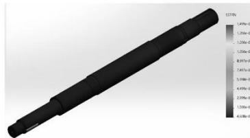
Модель із розрахованими деформаціями у матеріалі сталь 45
