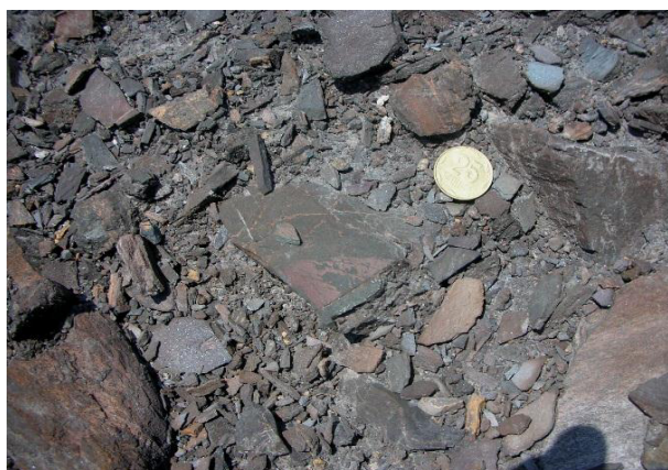
Рис. 6. Рудная «сыпучка» – один из продуктов маршаллитизации железнослюдко-мартитового кварцита Валявкинского месторождения.
