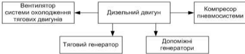
Рис.1 – Складові тягового електроприводу великовантажного автомобіля
