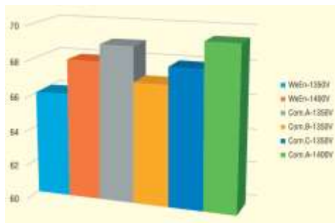
Рис.2 – Тестування на ріст температури корпусу модулів
