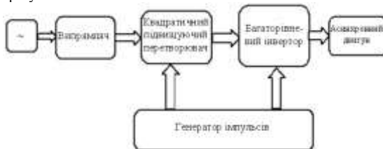
Рис.2 – Система керування асинхронним частотно-регульованим електроприводом
