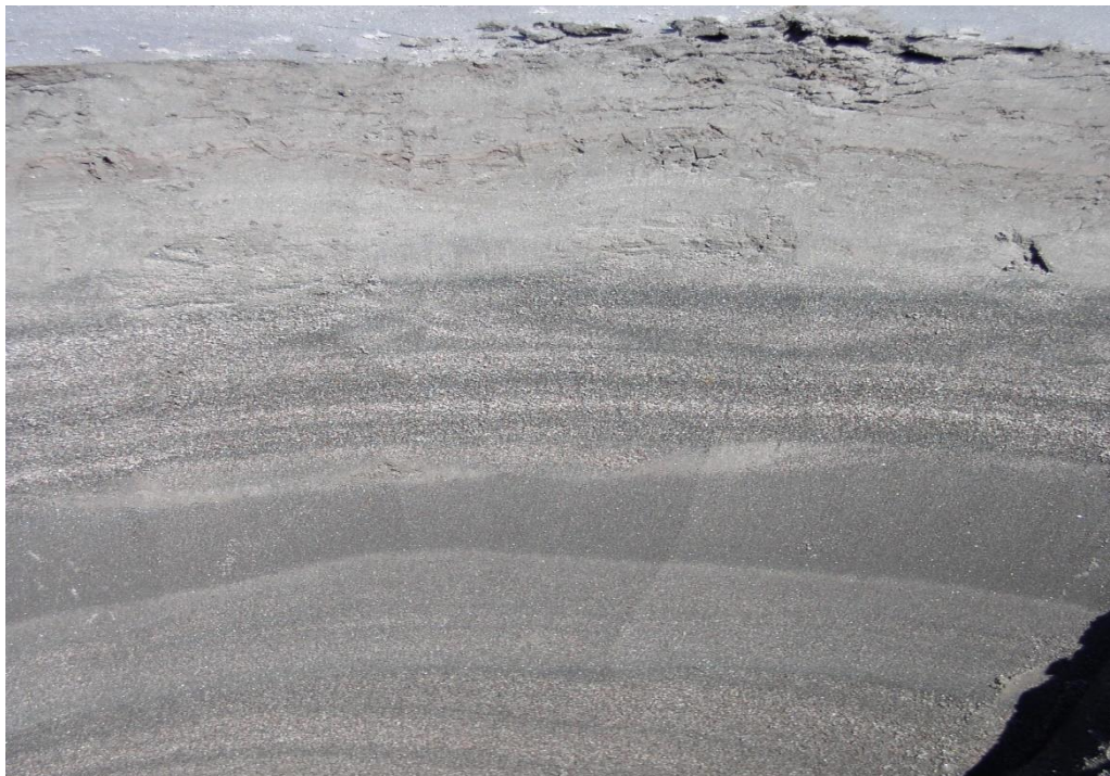
Рис 3.1 Мікрошарувата структура лежалих хвостів
