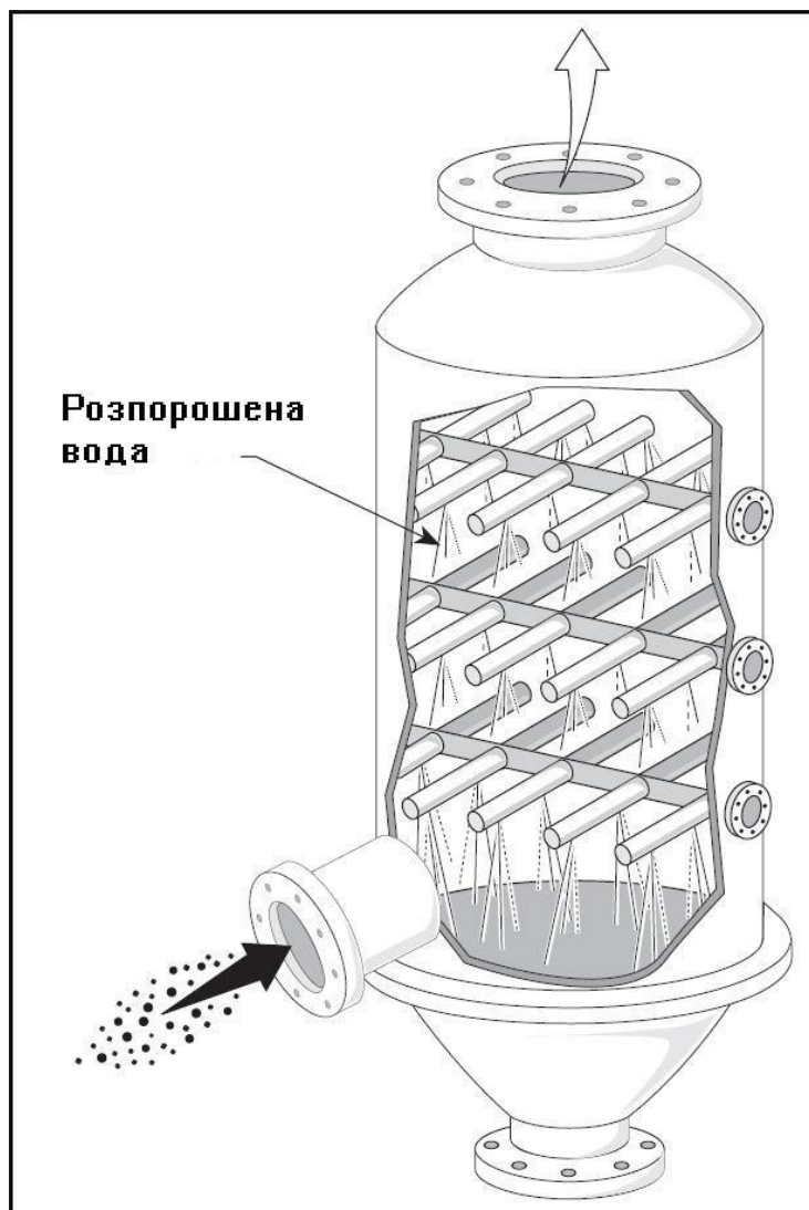
Схема 2.2. Полий скруббер. 1-корпус; 2-форсунки.
