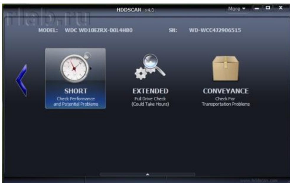
Рисунок 1.34 – Діалогове вікно SMART Tests
