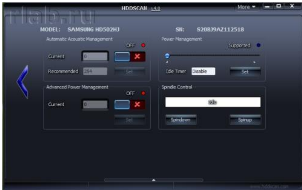
Рисунок 1.36 – Інформаційне вікно додаткових можливостей ATA/SATA Для SCSI накопичувачів програма дозволяє переглядати дефект-листи та запускати/зупиняти шпіндель.
