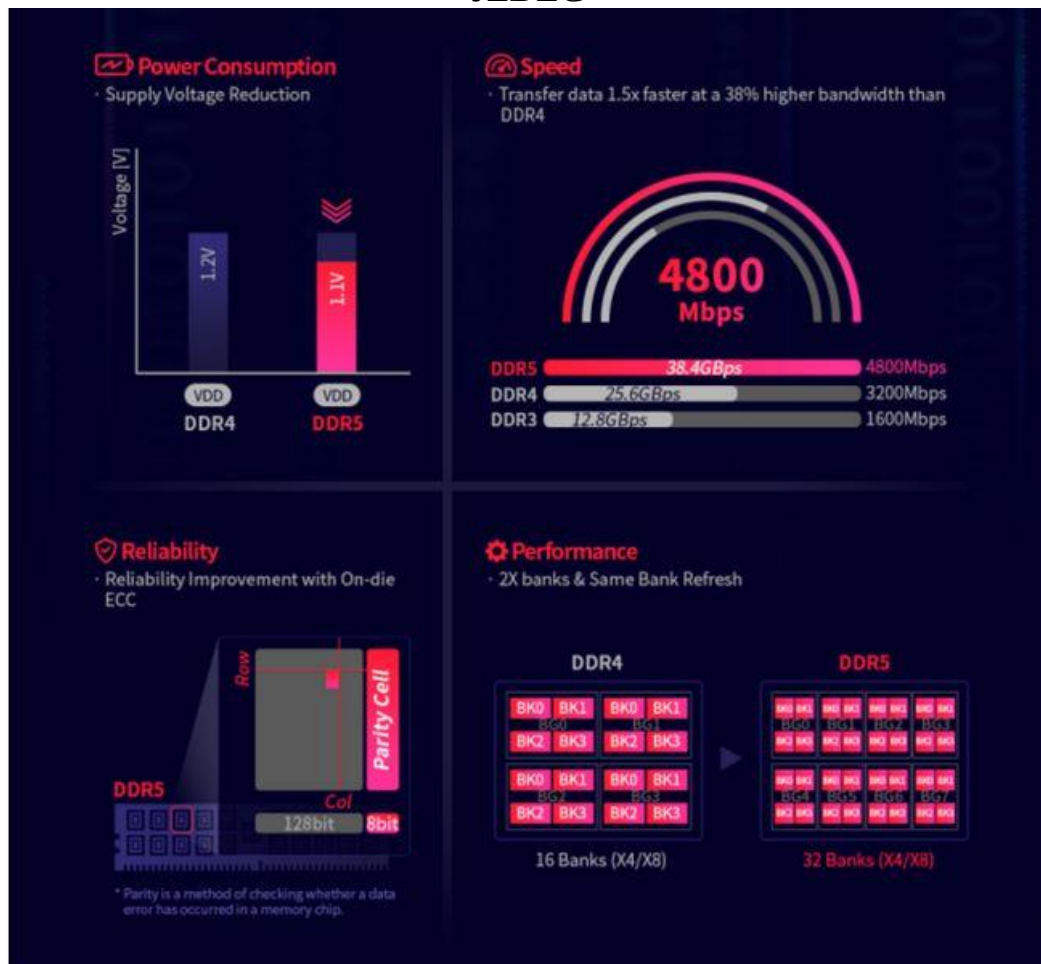
Рисунок 3.4 – Технічні характеристики оперативної пам'яті за стандартами JEDEC
