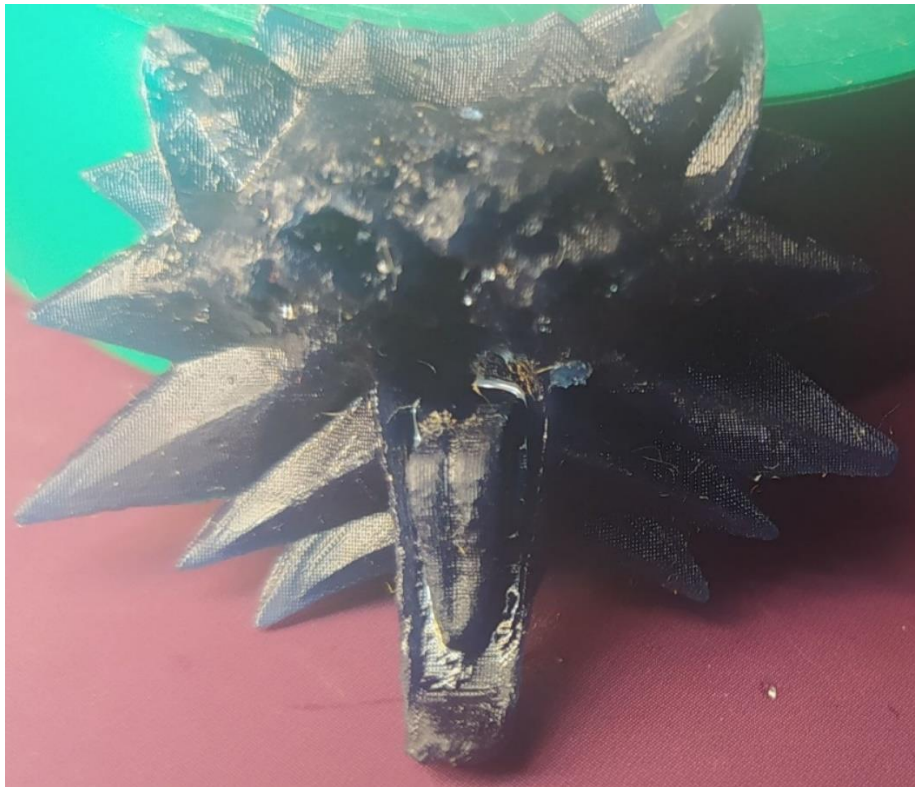
Рисунок 5.17 — Приклад недостатнього засвічення головних шарів
