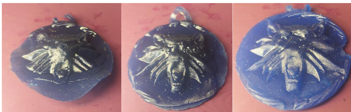
Рисунок 5.14 — Приклад недостатнього засвічення перших шарів деталі
