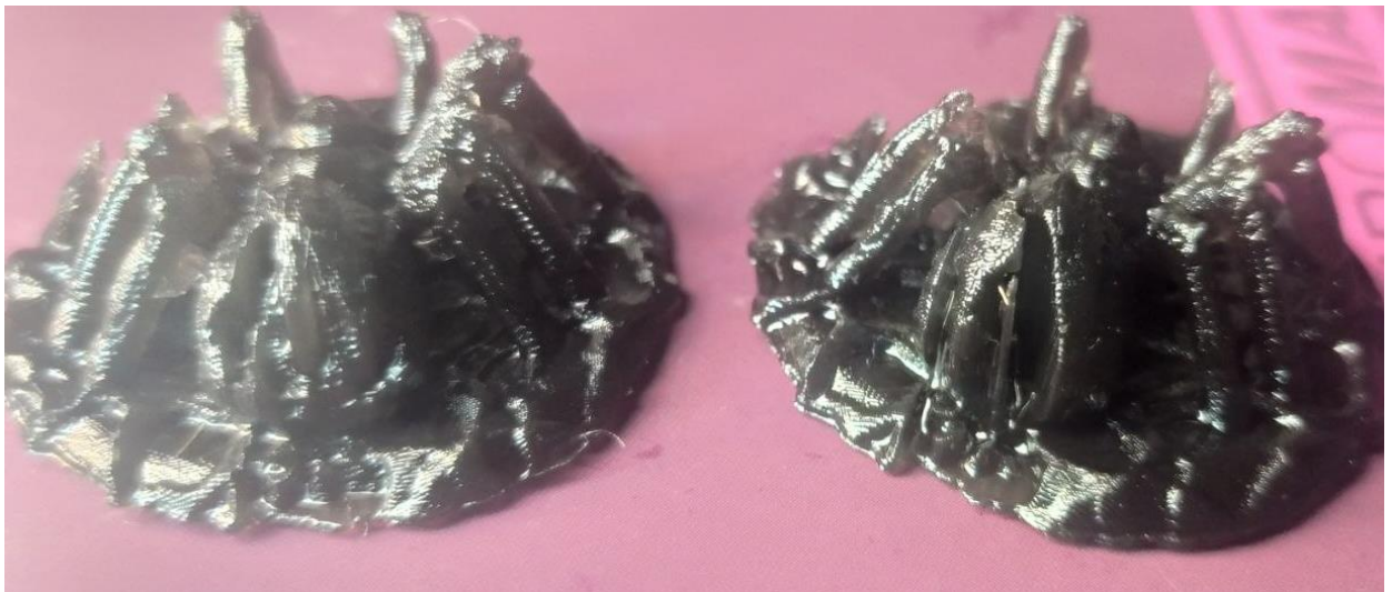
Рисунок 5.18 — Приклад впливу деформації плівки на модель
