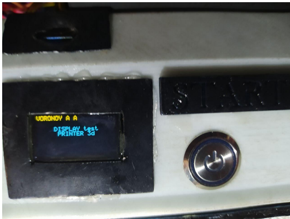
Рисунок 3.32 — Перевірка дисплею для виводу інформації
