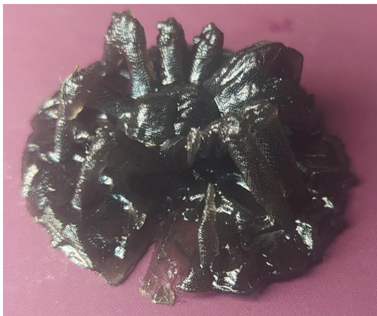
Рисунок 5.15 — Приклад надмірного засвічення початкових шарів
