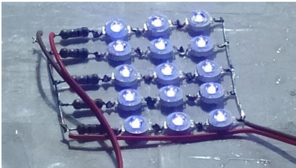
Рисунок 3.29— Перевірка ультрафіолетової підсвітки
