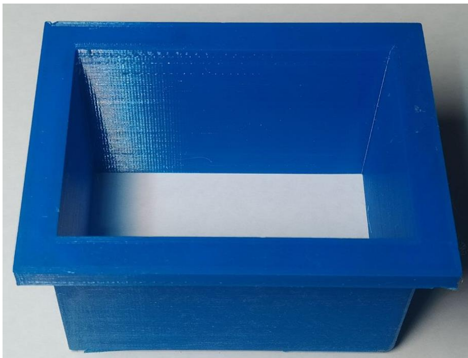
Рисунок 3.4 — Внутрішня частина корпусу ванни для фотополімеру
