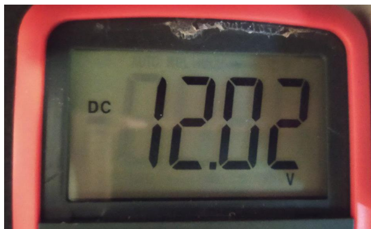
Рисунок 3.21 — Параметри вихідної напруги блоку живлення
