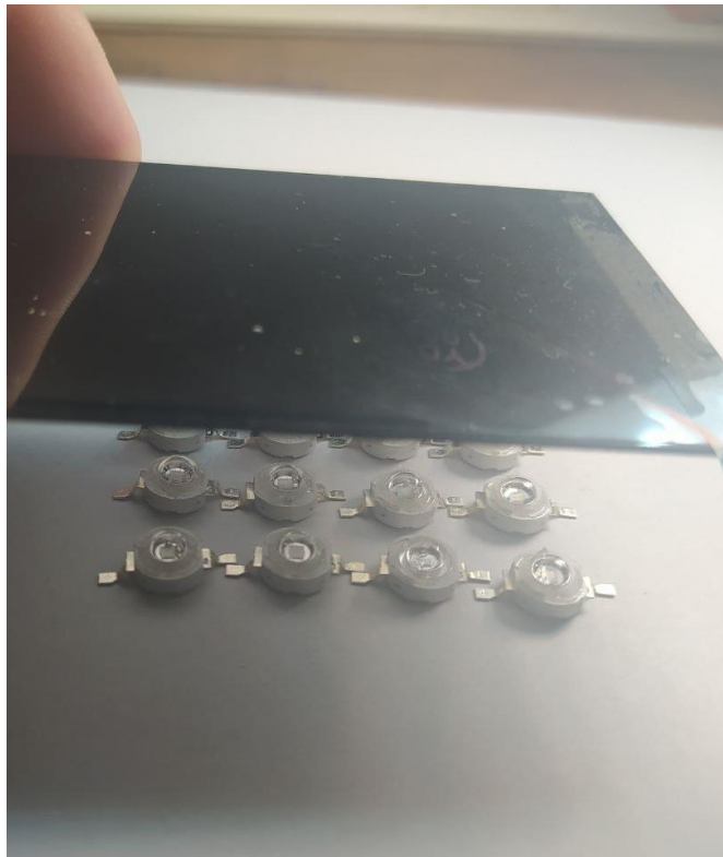
Рисунок 1.31 — Принцип взаємного розміщення світлодіодів та дисплею.
