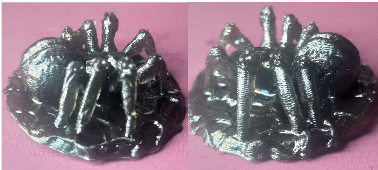
Рисунок 5.26 — Деталь 4-го етапу надрукована на фотополімерному принтері частин 2
