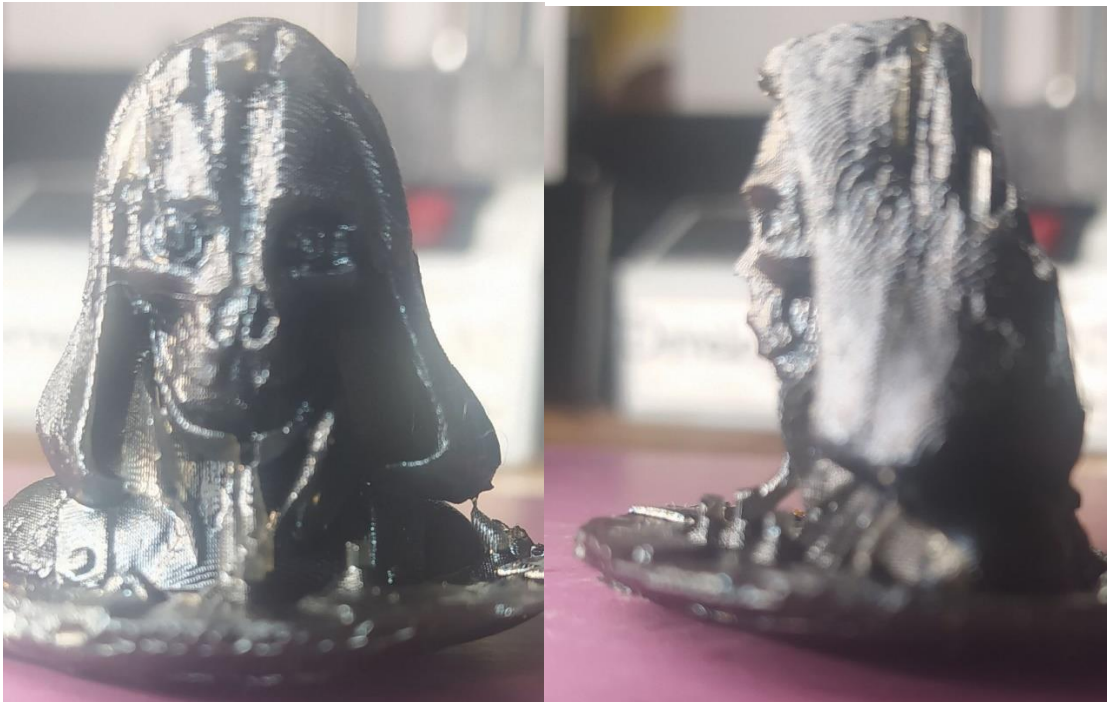
Рисунок 5.22 — Деталь 3-го етапу надрукована на фотополімерному принтері
