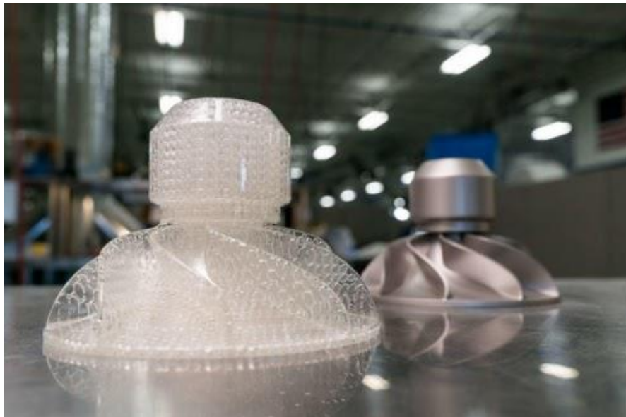
Рисунок 1.14 — 3д друк елемента аерокосмічного модуля
