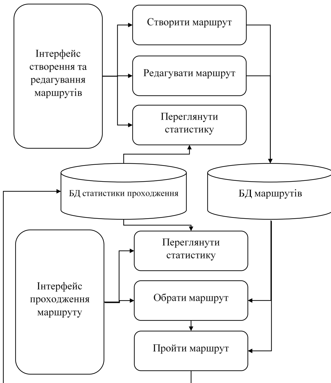
Рисунок 2.1 – Функціональна схема мобільної гри з орієнтуванням на місцевості
