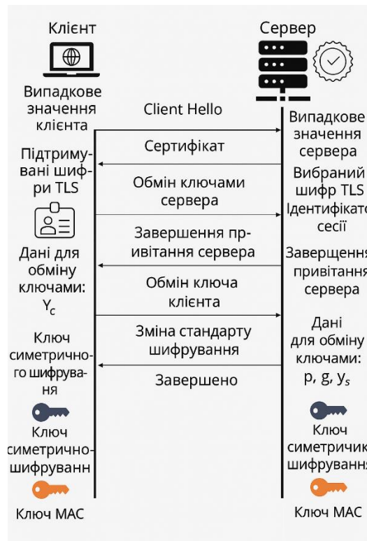
Рисунок 2.4 – Схема встановлення з'єднання за протоколом TLS 1.3
