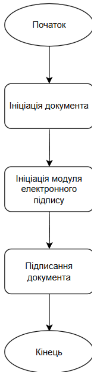
Рисунок 2.9 – Блок-схема алгоритму накладання електронного підпису
