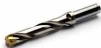
Рисунок 3.13 – Свердло для операції 015 2 перехід: SD107-25.00-175-25R7; Розміри (мм): D_c=25 ; l_4=175 ; l_2=264,5 ; l_{1s}=208,5 ; l_c=56,0 ; l_{3s}=188,5 ; D_{cby}=23,5 ; dm_m=25,0 ; D_{5m}=31
