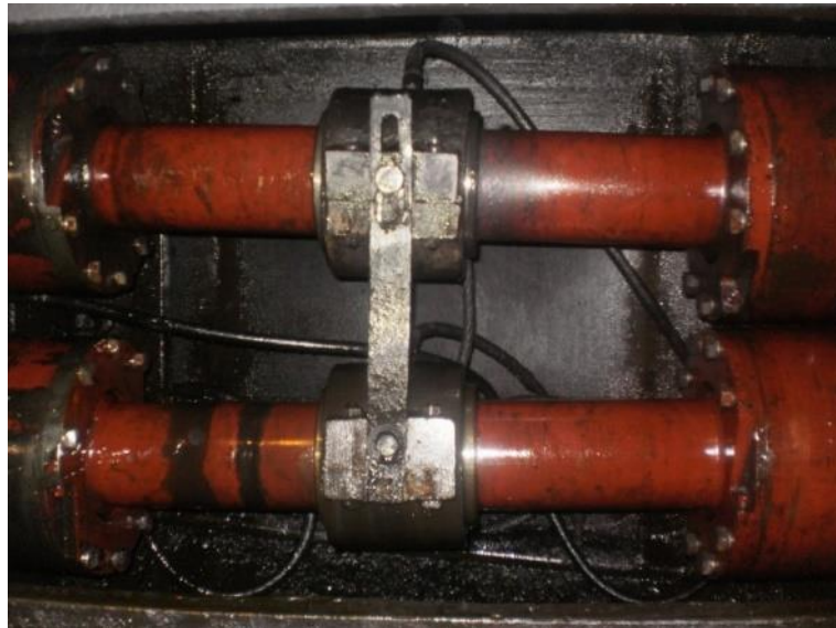
Рисунок 1.2 – Універсальний шаровий шпиндель установлений в прокатній кліті дротового стану
