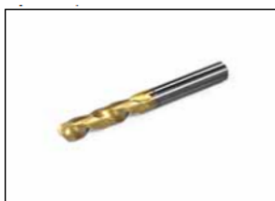
Рисунок 3.10 – Свердло для операції 010: SD203-20.0-49-20R; Розміри(мм): D_c=20,0 ; Макс. глибина свердління= 49 мм; l_2=131 ; l_1=81 ; l_c=50 ; l_6=79 ; dm_h6=20
