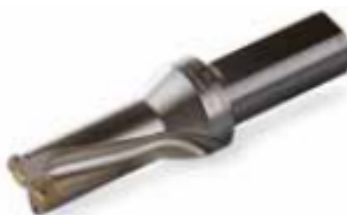
Рисунок 3.14 - свердло для операції 015 2 перехід: SD502-40-80-40R7 Розміри (мм): D_c=40 ; l_4=80 ; l_2=178 ; l_{1s}=110 ; l_c=68 ; l_{3s}=85 ; dm_m=40 ; D_{5m}=50 ; Центральна пластина: SPGX 12T3-C1 Периферійна пластина: SCGX 120408
